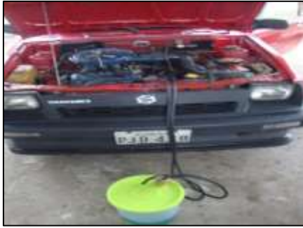
Fig.10: Tanque provisional Fuente: Tenorio A, Ulcuango C
