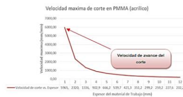
Fig. 5. Velocidad de corte máxima sugerida para diferentes espesores de PMMA con un láser de CO 2 de 80 W.
