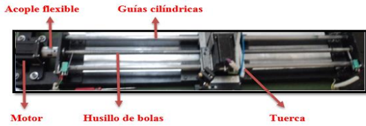
Fig. 14 Mecanismo desplazamiento del eje “Y”
