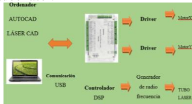
Fig. 11. Diagrama de bloques de las tarjetas controladoras.
