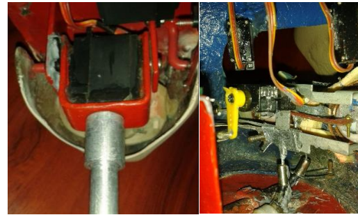
Figura 3.1 Acoplamiento del Servo del Cuello y de los Micro Servo.
