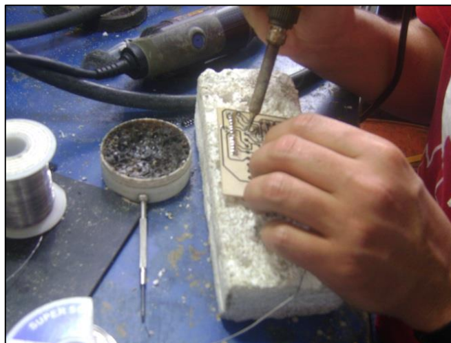
Figura 75: Soldadura de elementos
