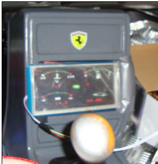
Figura 79: Comunicación de Arduino con la pantalla TFT.
