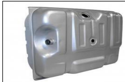
Figura 29: Tanque de combustible
