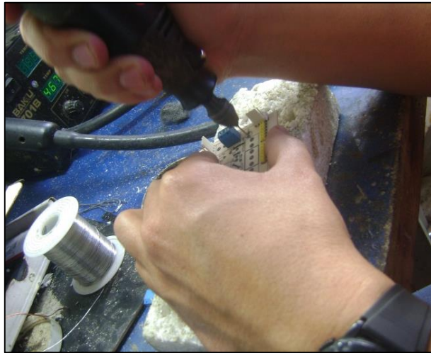
Figura 74: Perforación de la placa
