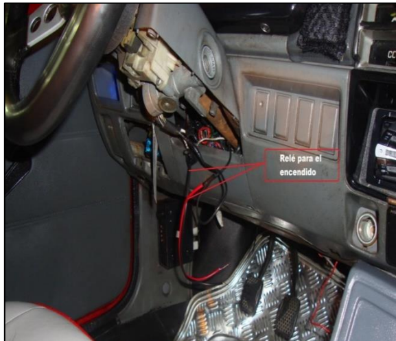
Figura 91: Relés de activación
