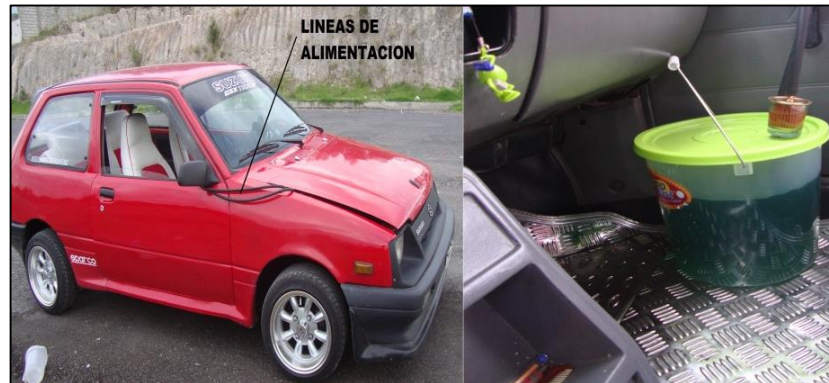
Figura 98: Ubicación del tanque provisional en el vehículo.
