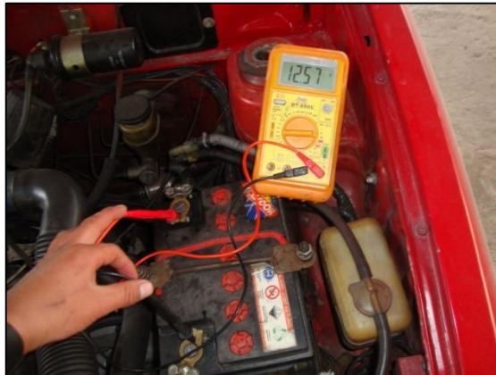
Figura 118: Voltaje de la batería.
