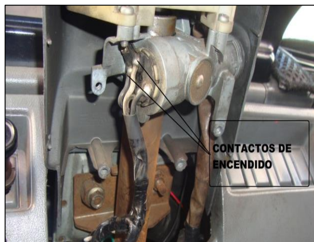
Figura 82: Contactos del switch de encendido
