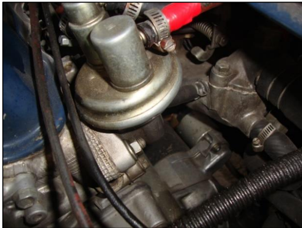
Figura 117: Bomba de alimentación de combustible.
