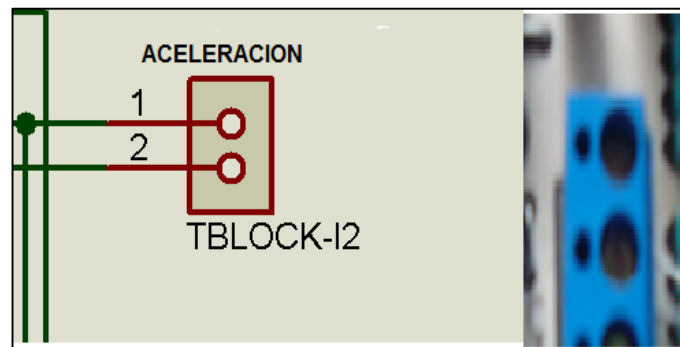
Figura 53: Bloque de conexión para el pedal del acelerador.
