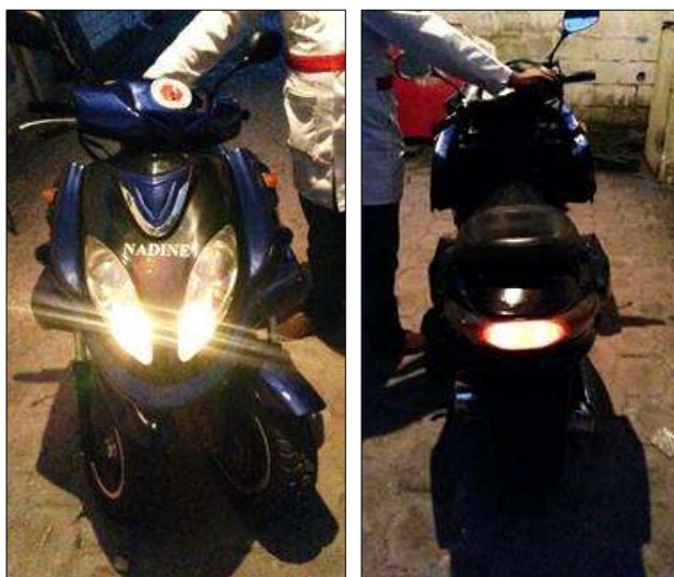
Figura 7-7: Comprobación de luces medias
