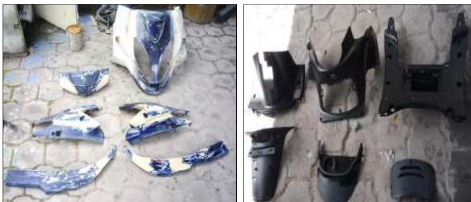
Figura 6-37: Preparación para pintura
