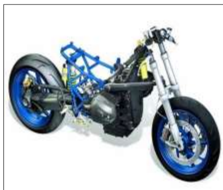
Figura 2-17: BMW HP2 Sport Boxer con motor estructural Fuente: Patxi Vergara, C. (2011). Modelado, análisis y simulación de un chasis de motocicleta. Universidad Carlos III. Madrid
