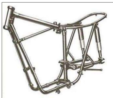
Figura 2-11: Chasis doble cuna Fuente: Patxi Vergara, C. (2011). Modelado, análisis y simulación de un chasis de motocicleta. Universidad Carlos III. Madrid
