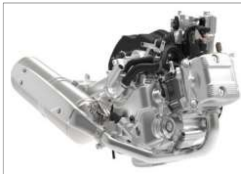
Figura 2-5: Motor piaggio 500cc/4 valvulas/refrigeración líquida. Fuente: http://www.motofan.com/
