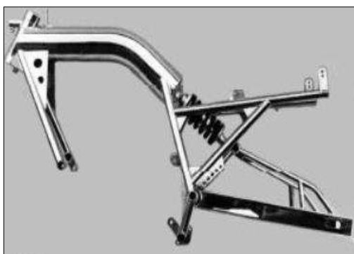
Figura 2-33: Sistema mono-shock con amortiguador inclinado Fuente: http://www.velocidadmaxima.com/
