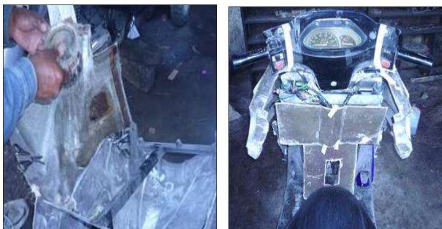
Figura 6-35: Recubrimiento fibra de vidrio
