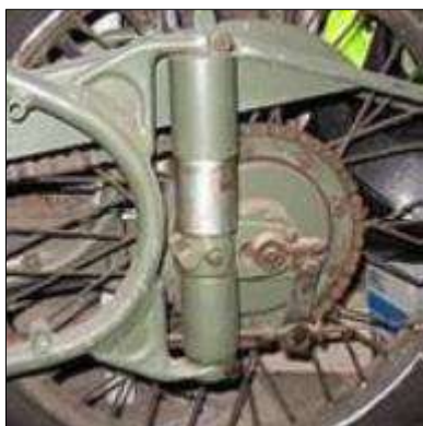
Figura 2-31: Sistema plunger Fuente: http://www.lamaneta.org/
