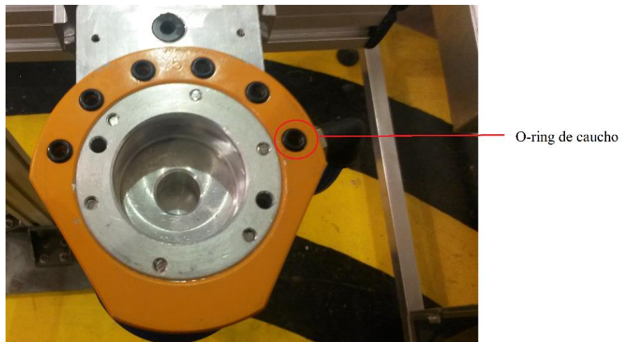
Figura 3.12 O-rings en el plato “tool”
