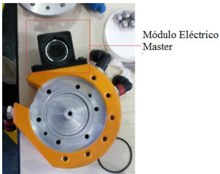
Figura 3.9 Módulo eléctrico “master”
