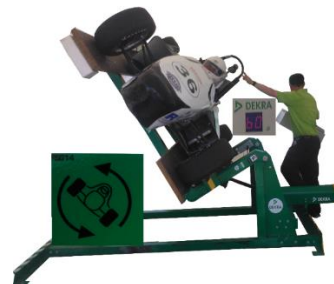
Figura 28: Prueba de inclinación del vehículo
