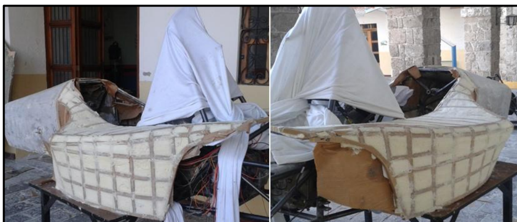
Figura 4.10 Relleno terminado de los sidepods
