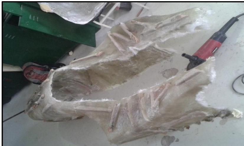
Figura 4.13 Primer negativo carrocería
