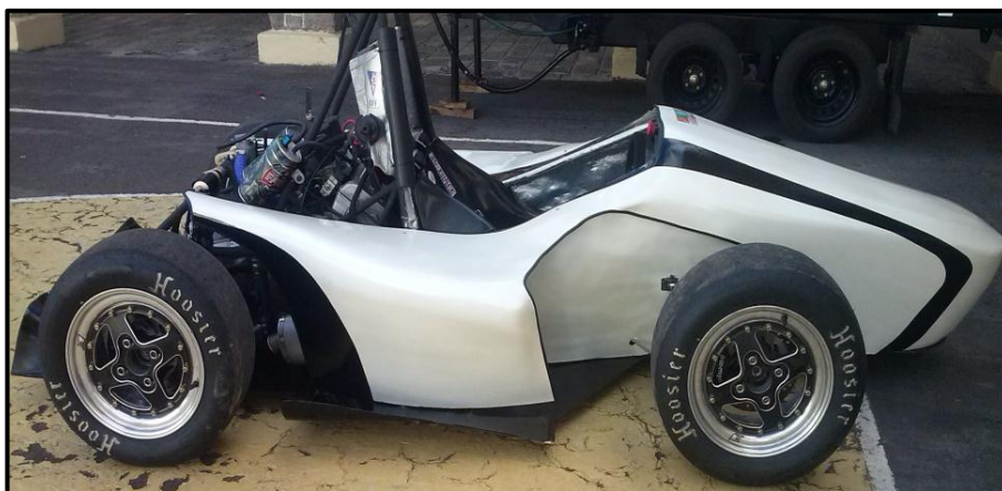
Figura 4.27 Carrocería colocada en el vehículo
