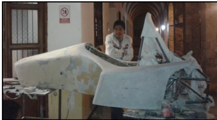
Figura 4.11 Acabado final del molde base
