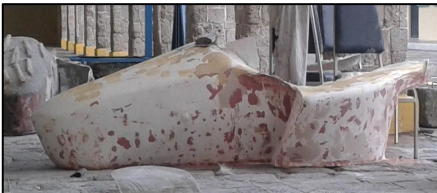
Figura 4.19 Masillado de la pieza final
