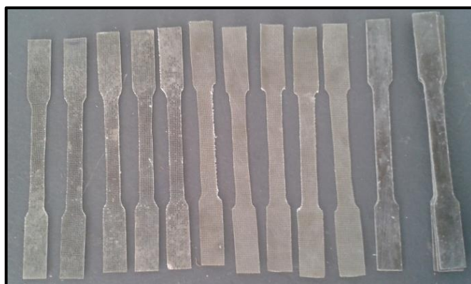
Figura 3.30 Probetas terminadas de diferentes materiales
