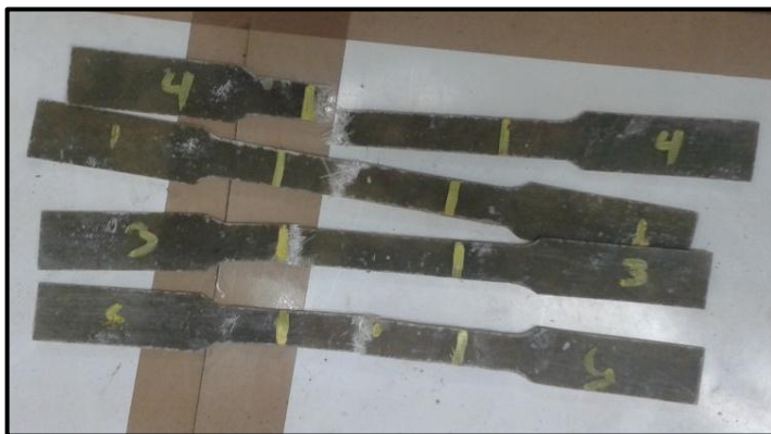
Figura 3.36 Ensayos realizados en las 5 probetas de fibra de vidrio
