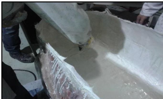
Figura 4.17 Aplicación de la fibra de yute
