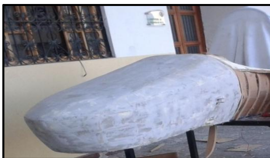
Figura 4.8 Masillado y lijado de la superficie
