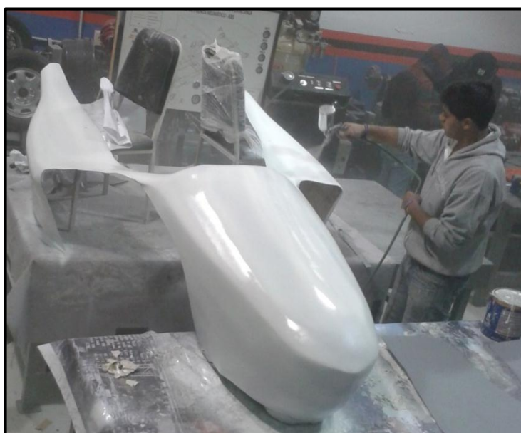
Figura 4.24 Aplicación final de pintura
