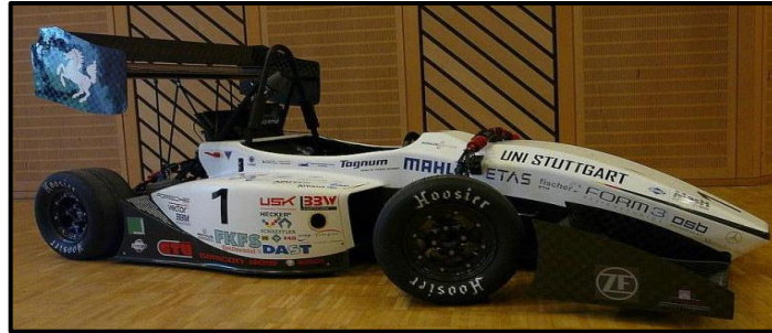
Figura 2.18 Chasis monocoque Universidad de Stuttgart Fuente: http://www.forocompeticion.com/foro/circuitos/10277-formula-sae-formula-student-temporada-2013-a.html
