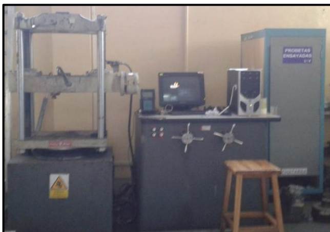
Figura 3.31 Máquina para ensayos de tracción
