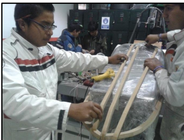
Figura 4.4 Armado de la estructura principal de la trompa
