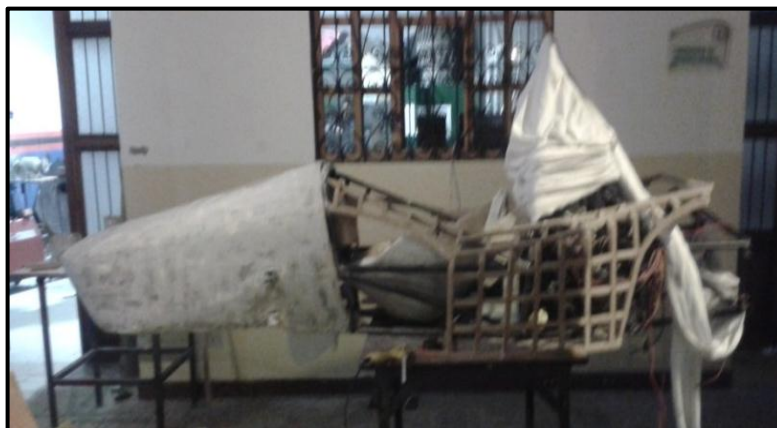
Figura 4.9 Estructura de los sidepods
