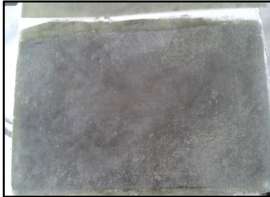
Figura 3.28 Plancha terminada de fibra mixta para probeta
