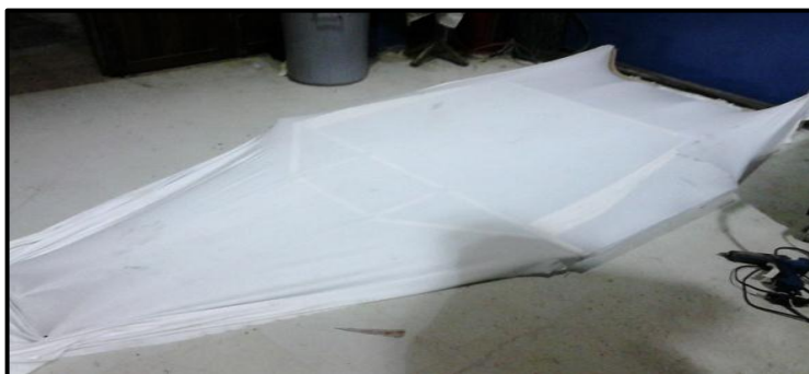
Figura 4.29 Recubrimiento de tela fondo plano
