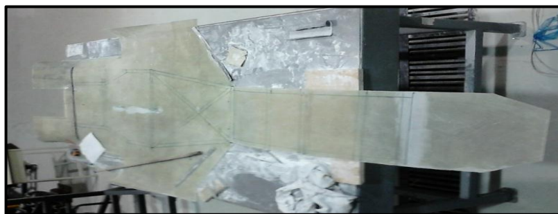
Figura 4.34 Molde negativo del fondo plano
