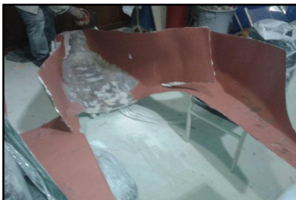
Figura 4.14 Proceso de masillado primer negativo
