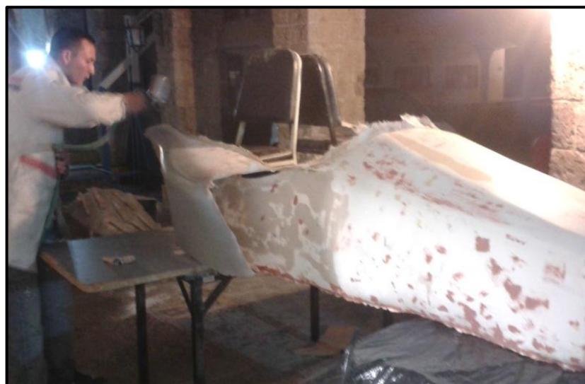
Figura 4.20 Aplicación de fondo gris
