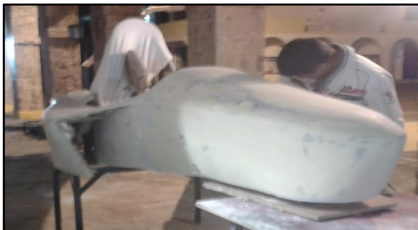
Figura 4.12 Aplicación de cera desmoldante
