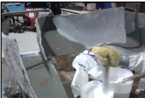
Figura 4.15 Aplicación fondo gris en la superficie
