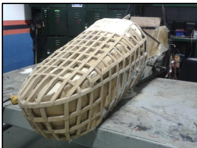
Figura 4.6 Colocación de cartón en la estructura
