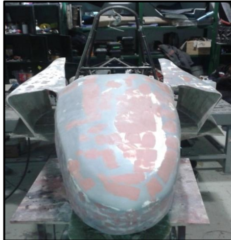
Figura 4.21 Último masillado de la carrocería
