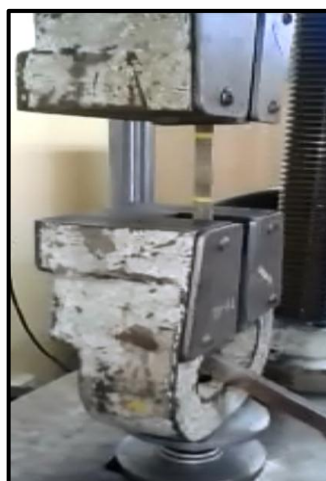
Figura 3.34 Colocación de las probetas para el ensayo de tracción
