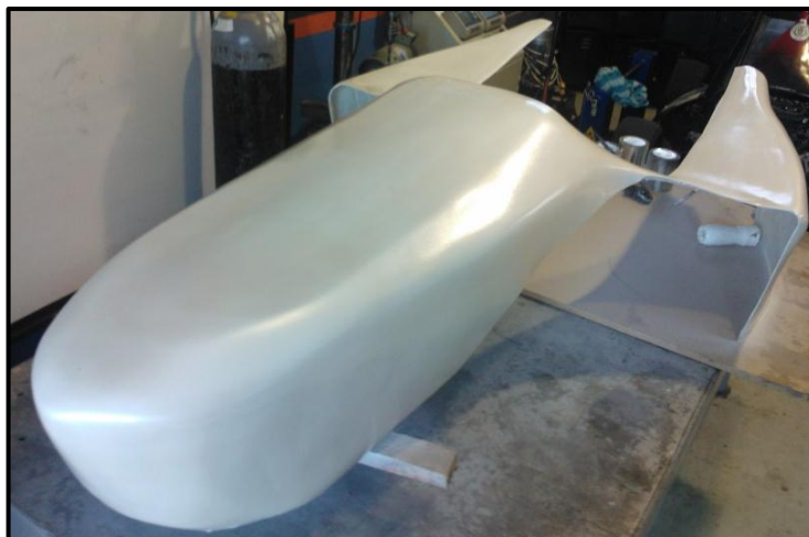
Figura 4.25 Acabado final tricapa en la carrocería
