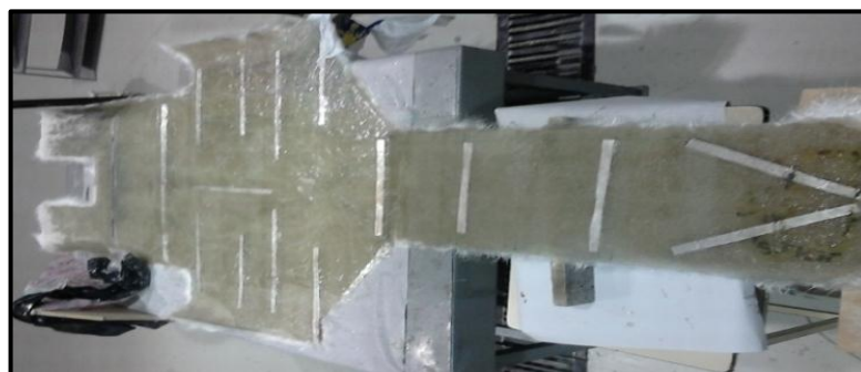
Figura 4.35 Segundo positivo del fondo plano
