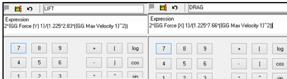
Figura 3.14 Ingreso ecuación del Drag y Lift
