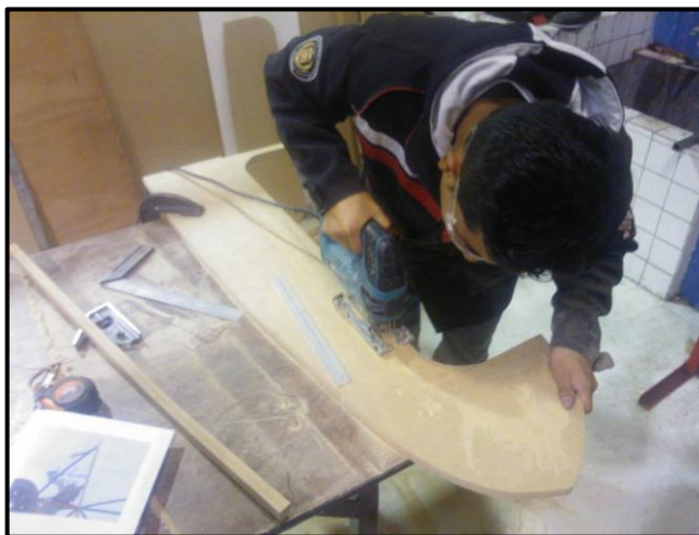
Figura 4.3 Corte de madera MDF
