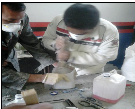
Figura 4.32 Preparación de masilla con talco industrial
