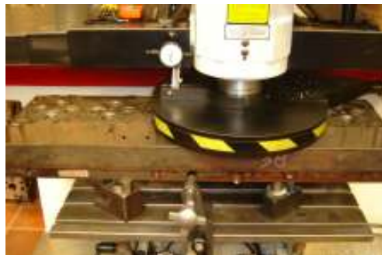
Fig. 2.5 Rectificación de planitud de culata
