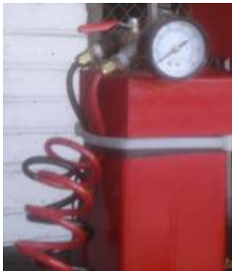
Fig. 5.3 Manómetro y llave de control de presión de aire
