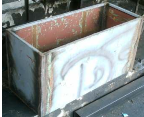
Fig. 4.6 Tanque armado y soldado
