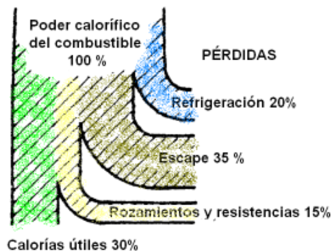
Fig. 1.1 Porcentajes de pérdidas de calor en el motor
