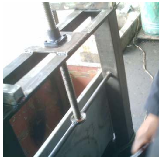
Fig. 4.18 Armazón con los rieles de los brazos
