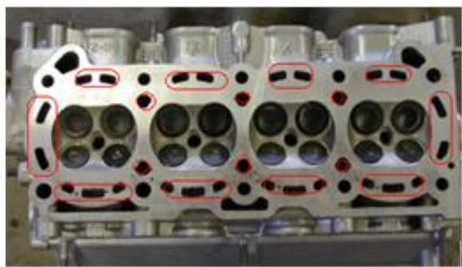
Conductos de refrigeración
