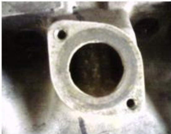
Salida de agua hacia el radiador
