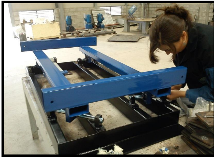
Figura 138. Ensamble del sistema de alineación
