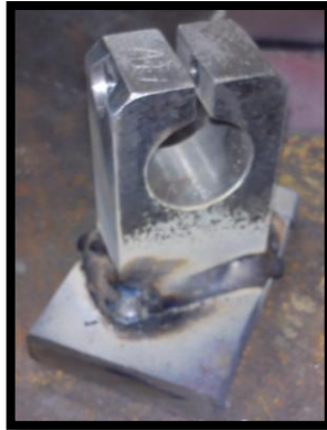
Figura 130. Proceso de soldeo de placa de soporte.
