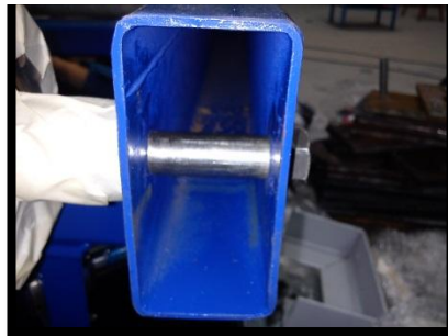
Figura 139. Colocación de espaciadores en los rodillos del alineador.
