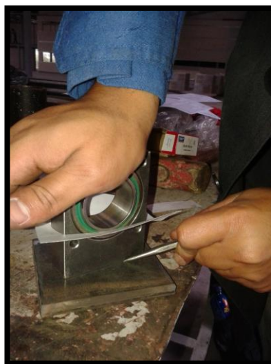
Figura 131. Ubicación de placas de soporte para el alojamiento rótula-rodamiento.
