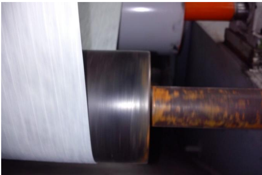
Figura 164. Desplazamiento lateral de la lámina en el rodillo de impregnación con el sistema de alineación apagado.
