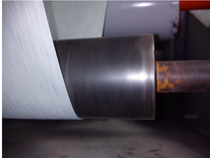
Figura 165. Desplazamiento lateral de la lámina en el rodillo de impregnación con el sistema de alineación apagado.
