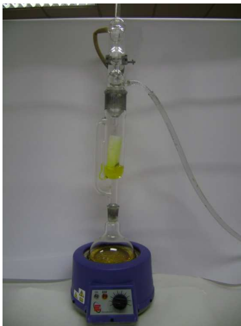
Figura 3: Equipo Soxhlet usado para la extracción de curcuminoides
