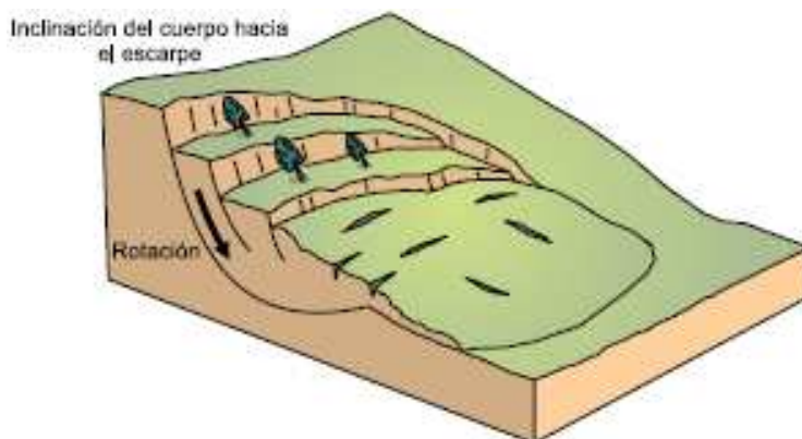
Figura 7 Esquema de un deslizamiento rotacional Fuente: GEMMA, 2007
