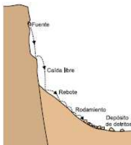
Figura 2 Esquema de la caída de rocas Fuente: (GEMMA, 2007)
