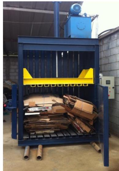
Figura 10. Compactadora automática.
