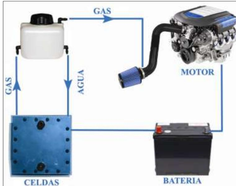
Figura 2-3 Diagrama de inyección de hidrógeno
