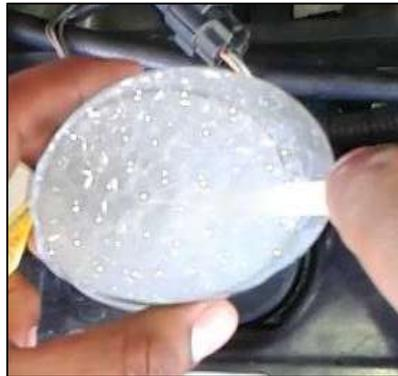
Figura 3-10 Burbujas de hidrógeno
