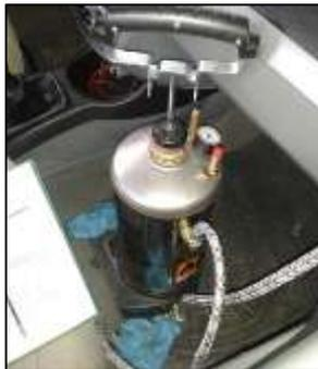
Figura C-1 Canister para pruebas de combustible
