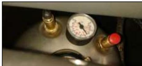
Figura C-8 Purga de la presión del canister
