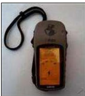
Figura C-5 Dispositivo GPS para medición de distancias y tiempos en pruebas de consumo
