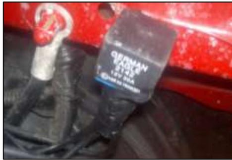
Figura 3-8 Relé de encendido del sistema
