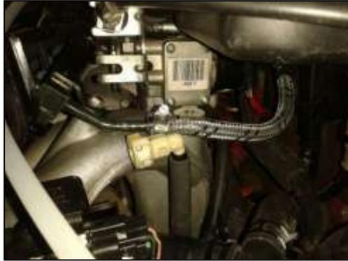
Figura C-3 Conexión de canister al tren de inyectores del vehículo
