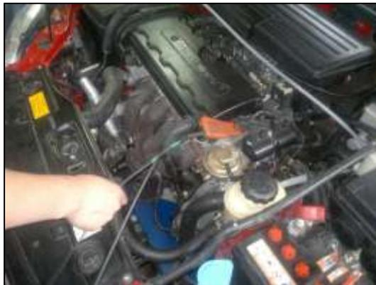
Figura A-10 Colocación de la sonda para medición de la temperatura del motor
