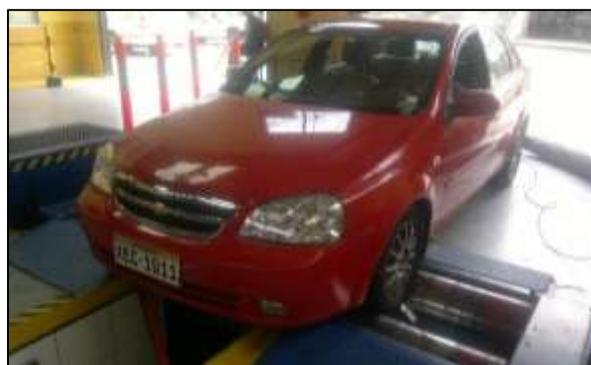
Figura A-7 Colocación del vehículo en el dinamómetro para pruebas de torque y potencia
