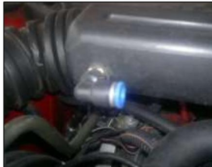
Figura 3-4 Acople de entrada de hidrógeno al motor
