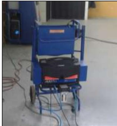
Figura B-1 Analizador de gases de escape MGT5
