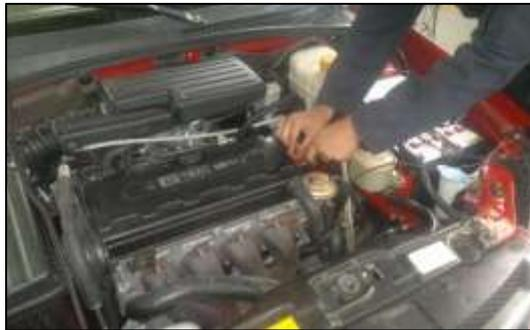
Figura A-9 Conexión de la pinza inductiva para medición de RPM
