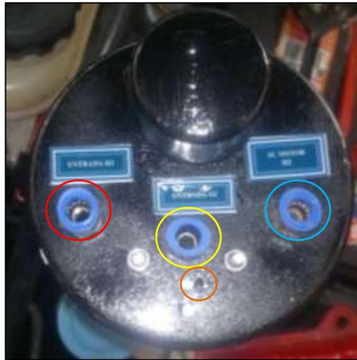
Figura 3-3 Racores de conexión ubicados en el depósito
