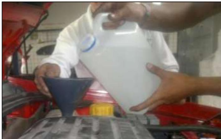
Figura 3-9 Preparación y ubicación del electrolito
