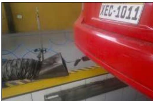
Figura B-6 Colocación del medidor en el escape del vehículo
