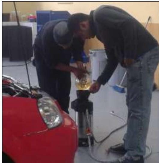
Figura C-4 Llenado del canister con 5 lt de combustible para prueba de consumo
