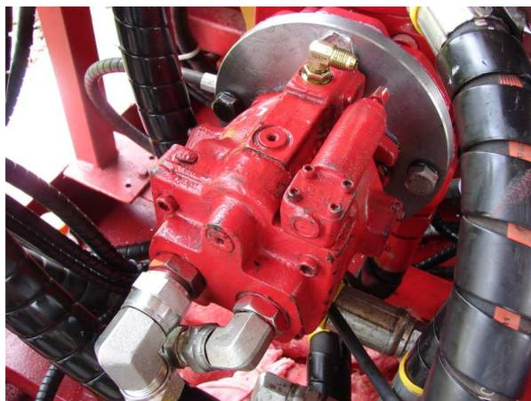
**Figura 71** Acoplamiento de bomba a PowerPack
