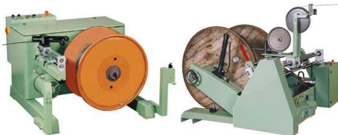
**Figura 9** Máquinas estacionarias de enrollado de cable
