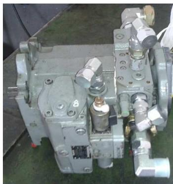
**Figura 20** Bomba hidráulica del sistema
