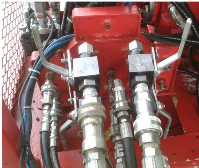
**Figura 73** Instalación válvulas de control de flujo
