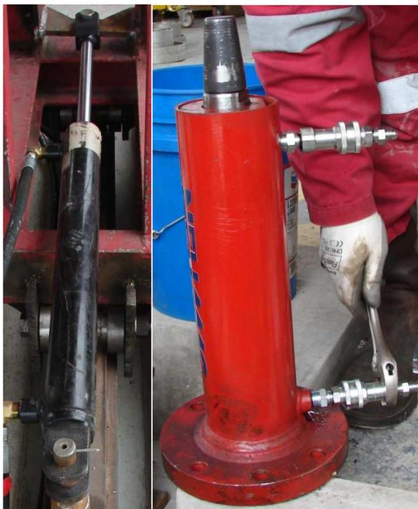
**Figura 75** Cilindros de desplazamiento de máquina y elevación de bandeja
