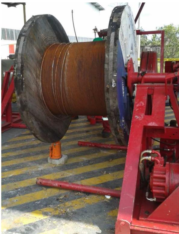
**Figura 4** Carrete soportado por gato hidráulico de camión
