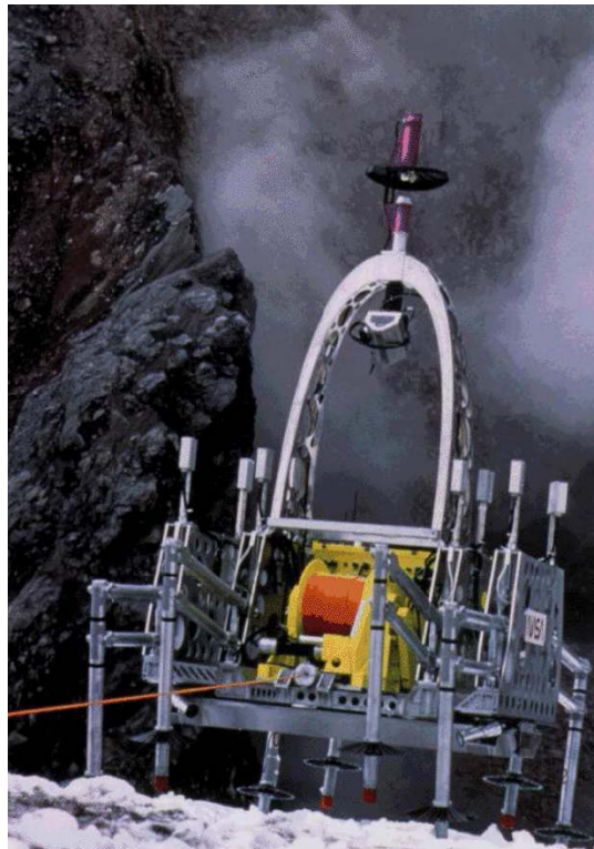
Figura 3.6 Dante II descendiendo al interior del Cráter del Monte Spurr
