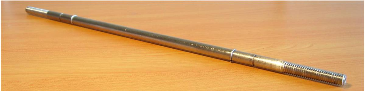
**Figura 6.5 Eje soporte de cilindros**
