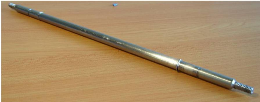
**Figura 6.6 Eje soporte de rodachines**
