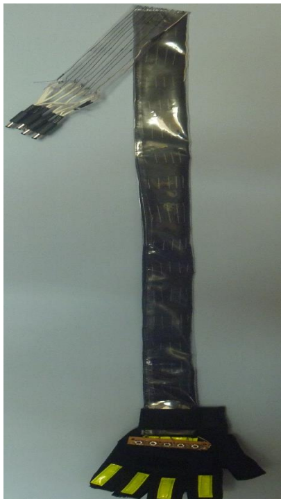
Figura 21: Guante de control y conectores plugs.
