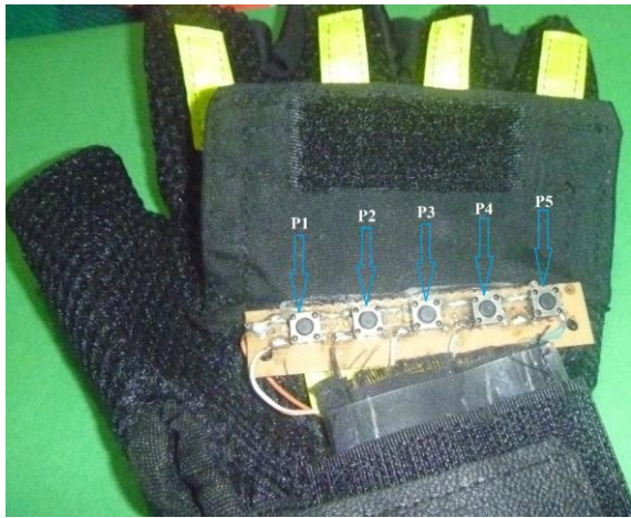
Figura 20: Guante de control con los pulsadores de activación de funciones
