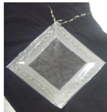
Figura 16: Implementación de las luces indicadores de dirección.
