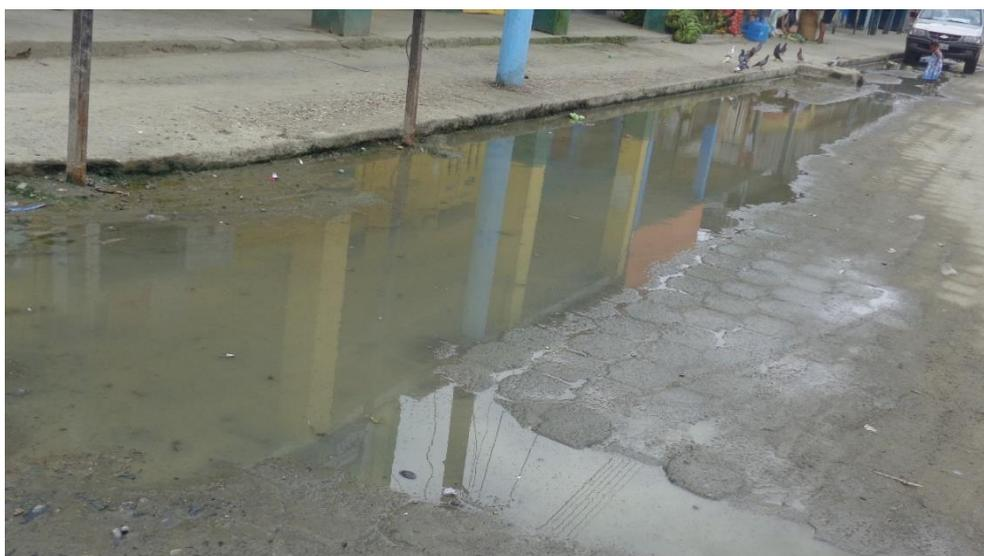
**Figura. 55** Acumulación de agua en las calles por la insuficiencia de alcantarillado, isla Muisne.
