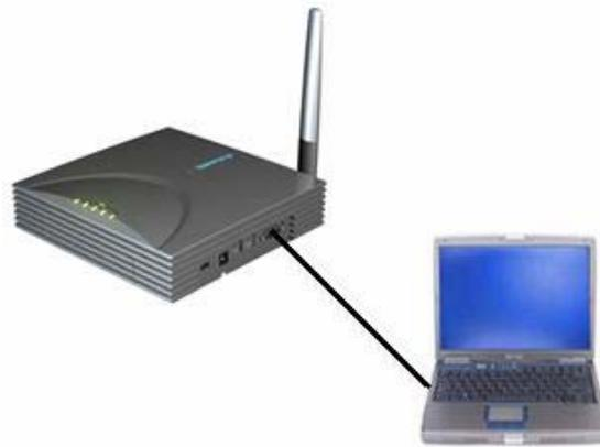
**Figura 4.2. Equipo para servicios de transmisión de datos con conector USB**
