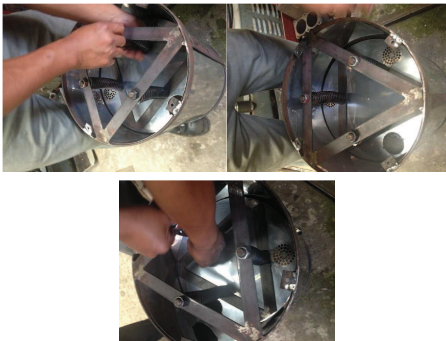
Figura 78. Sistema de rotación de BP., vibratorio en la base del cilindro de almacenamiento.
