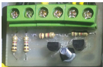
Figura 132. Placa del circuito de acople de señal de los sensores de la máquina.
