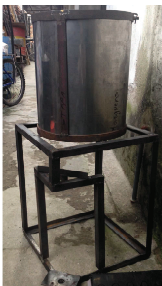
Figura 105. Fases de la construcción de la base principal de la maquina almacenadora, conservadora y dosificadora de BP.
