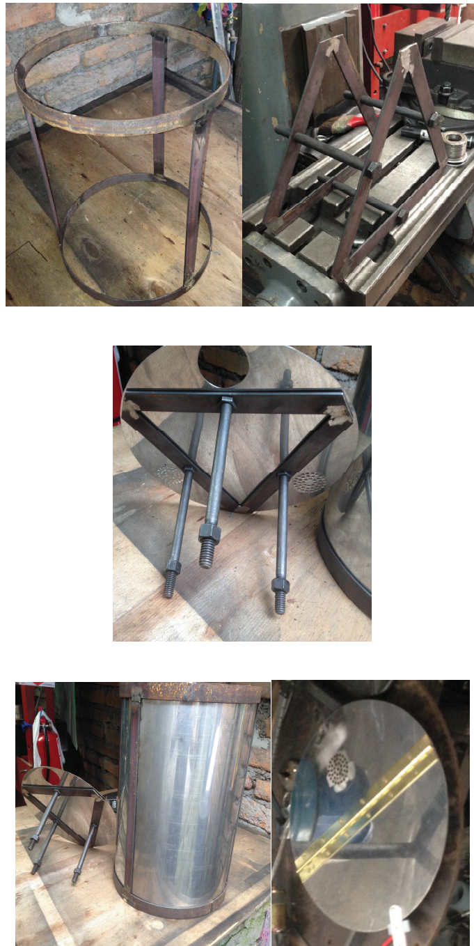
Figura 103. Construcción del cilindro de almacenamiento de BP., en cada una de sus fases.
