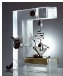
Figura 25. Primer transistor realizado por físicos W. Shockley, J. Bardeen y W. Brattain
