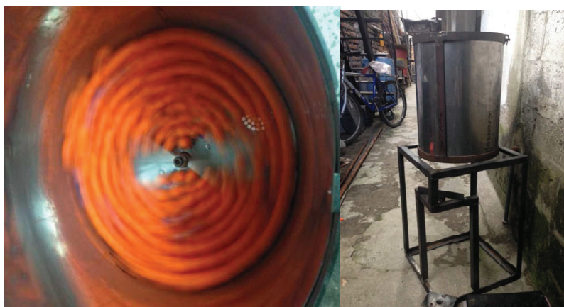
Figura 79. Sistema de rotación de BP., de aspa giratoria, en el cilindro de almacenamiento.
