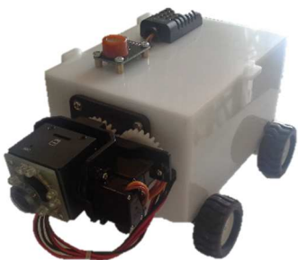
Figura 15. Imagen Robot para Inspección Visual de Tubería
