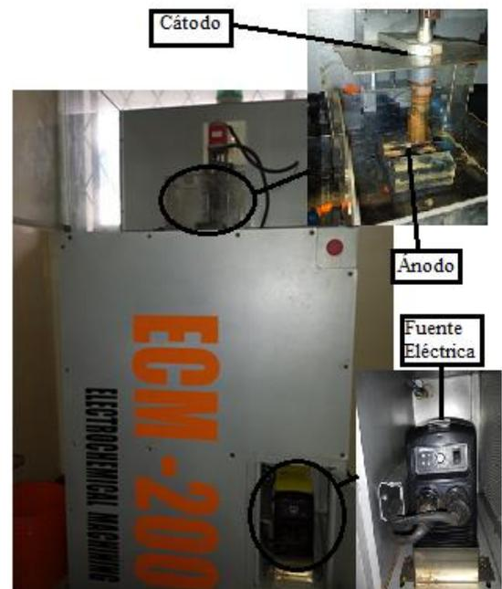
Figura 8. MODULO DE FUENTE ELÉCTRICA
