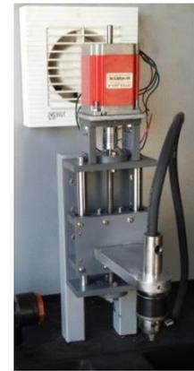
Figura 12. SISTEMA DE AVANCE DE LA HERRAMIENTA
