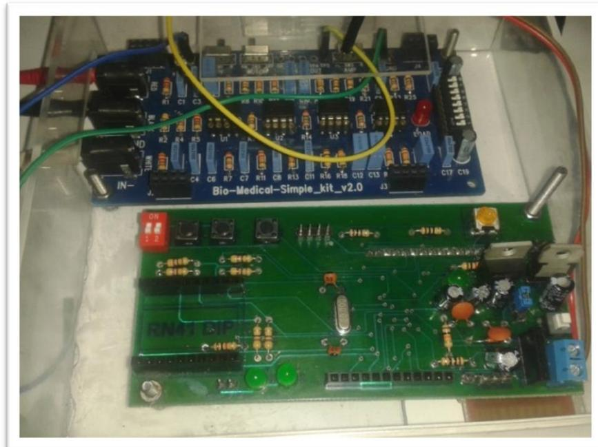
**Figura 105. Conexión tarjeta principal y tarjeta de adquisición de señales**
