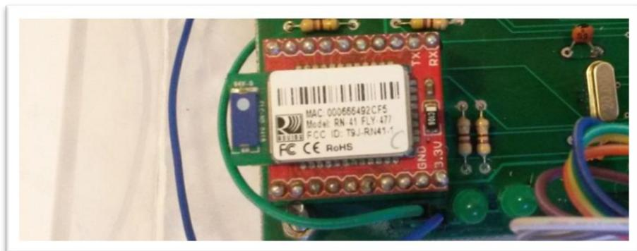
Figura 119. Montaje de Bluetooth en tarjeta principal.
