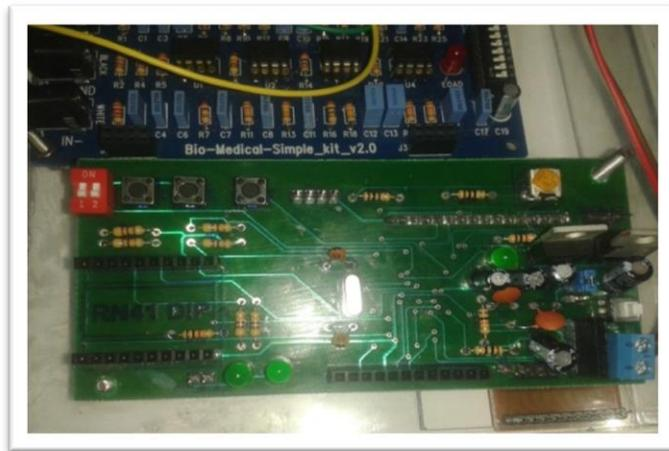
**Figura 116. Montaje de tarjeta principal del prototipo en caja de acrílico.**
