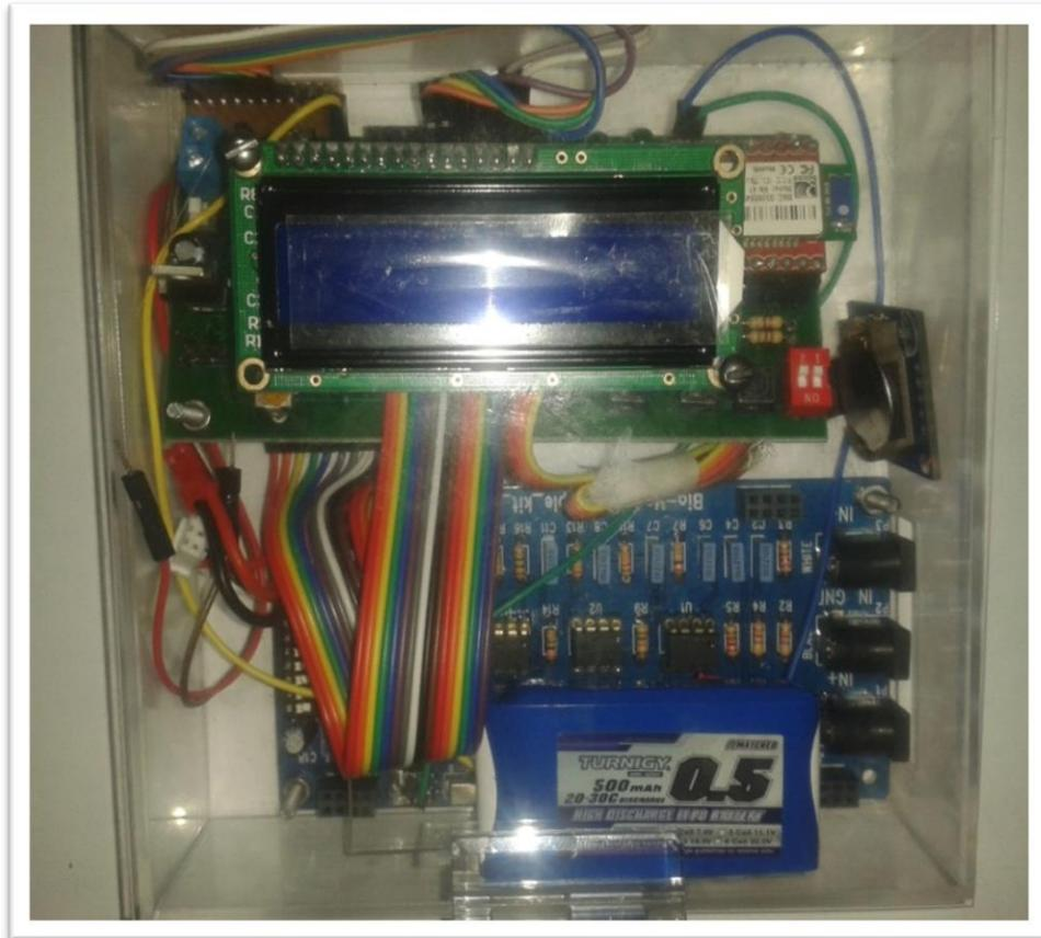
**Figura 121. Montaje completo del prototipo ECG en caja de acrílico.**
