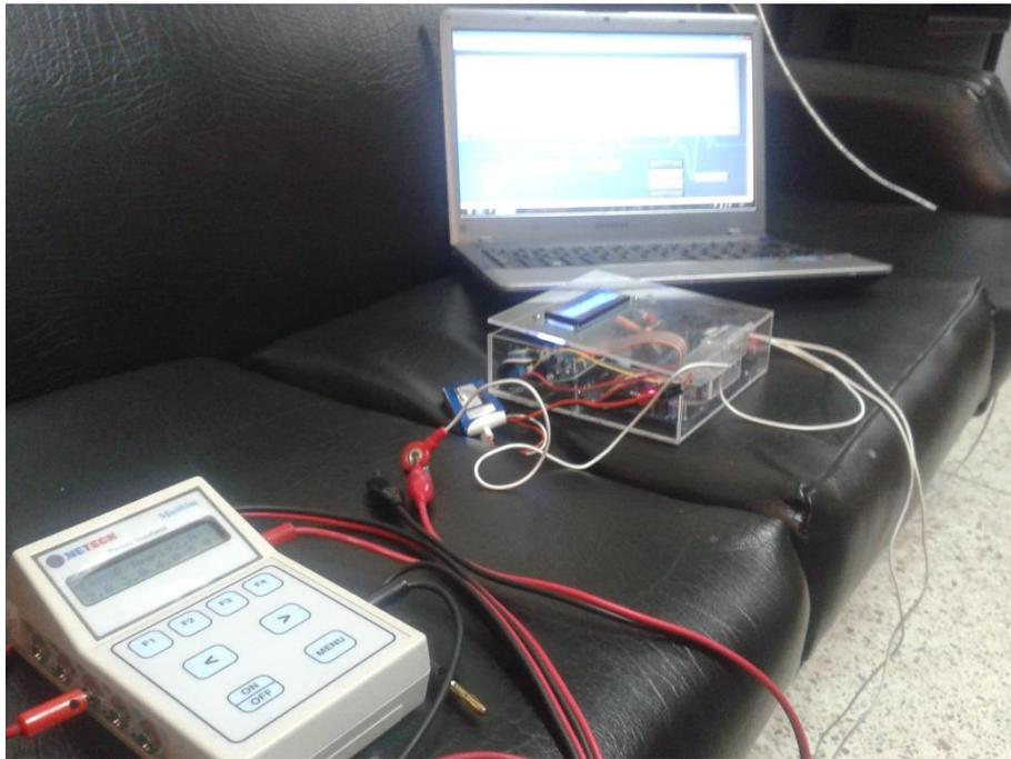
**Figura 132. Conexión prototipo ECG - Simulador Netech**
