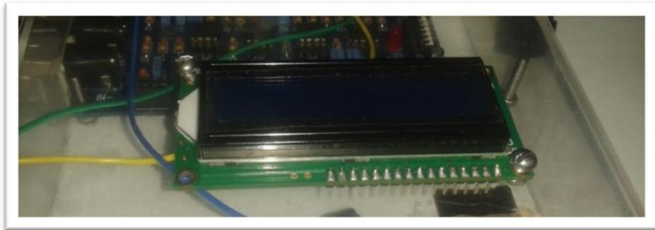
Figura 118. Montaje de LCD en caja de acrílico.
