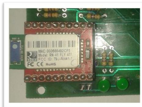
**Figura 107. Conexión tarjeta principal y módulo Bluetooth**
