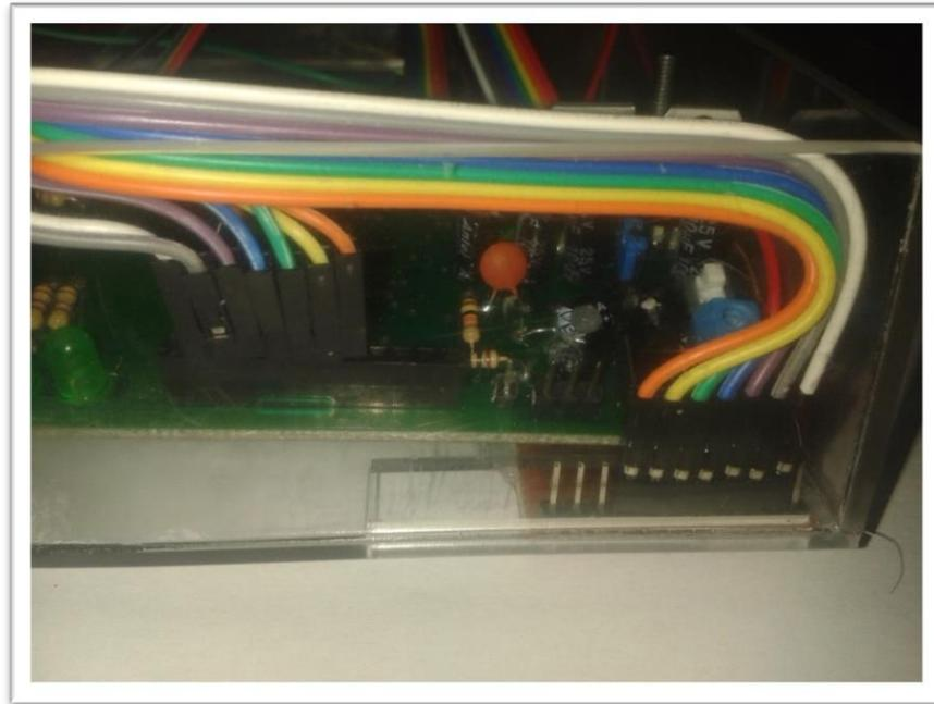
**Figura 106. Conexión tarjeta principal y tarjeta SD**
