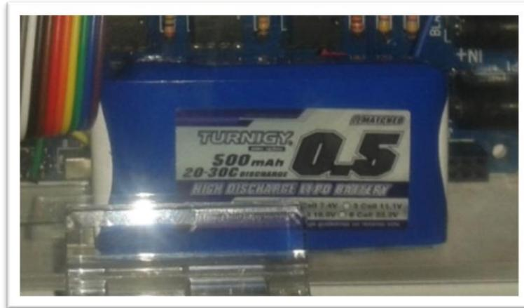
**Figura 120. Montaje de batería en tarjeta principal.**
