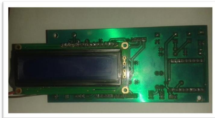
**Figura 108. Conexión tarjeta principal y LCD**
