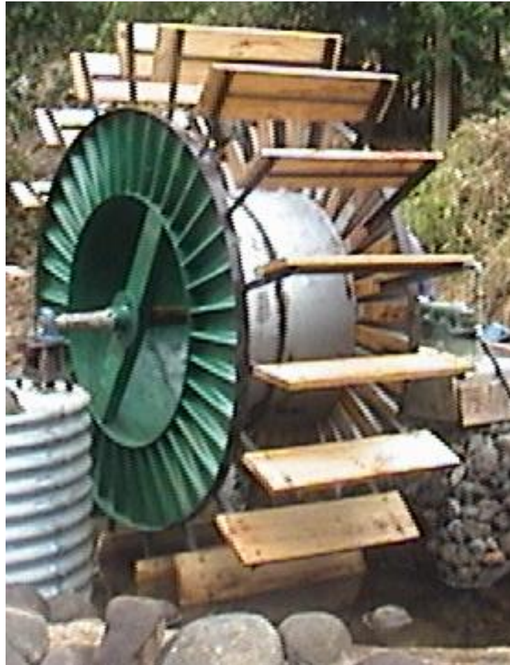
Figura 4.13 Rodete utilizado para la rueda hidráulica
