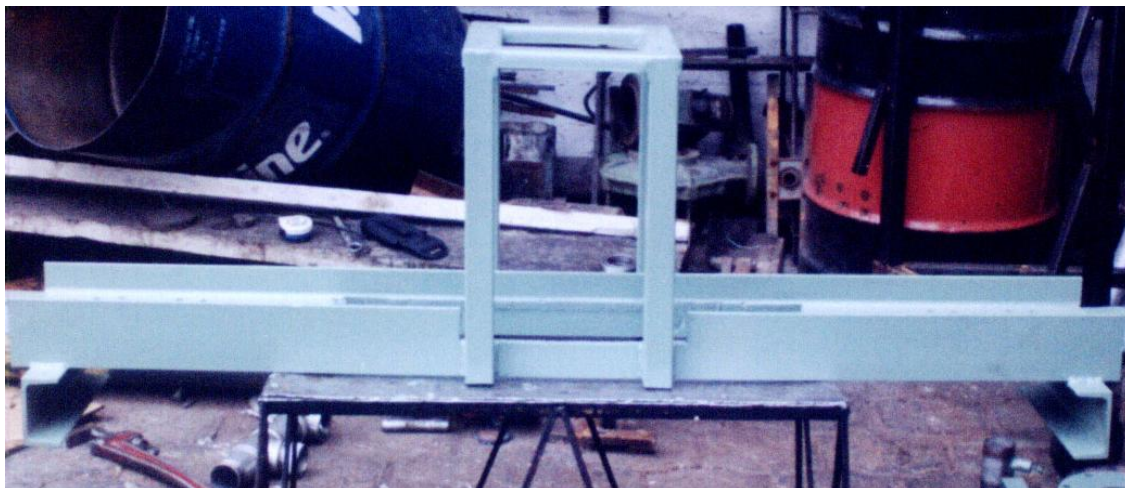
Figura 4.14 Bastidor de la bomba de desplazamiento positivo
