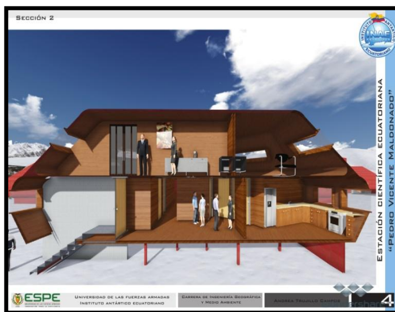
Figura 74. Corte Transversal Módulo Administrativo, Vivienda y Servicios
