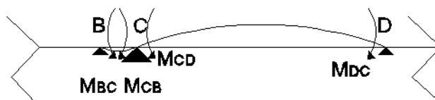
Figura 25 Rotación unitaria en C, diagrama de momentos
