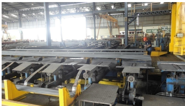
Figura 8 Varilla corrugada de ANDEC
