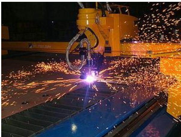
Figura 13 Corte por Plasma
