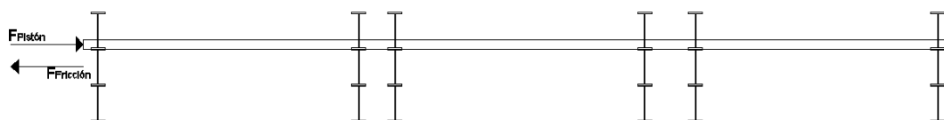
Figura 50 Vista frontal fuerza de cilindros hidráulicos en barra cuadrada para igualar palanquillas
