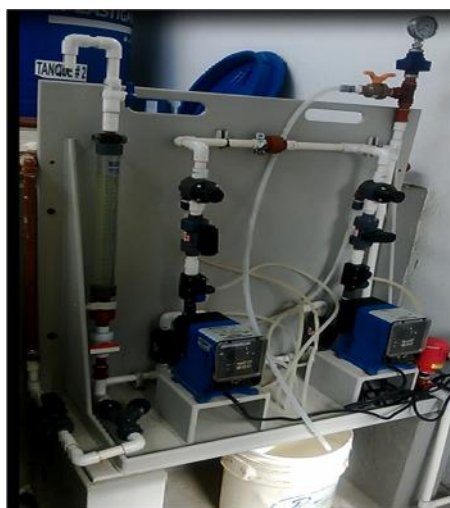
Figura 42. Sistema de dosificación con Hipoclorito de Sodio.
