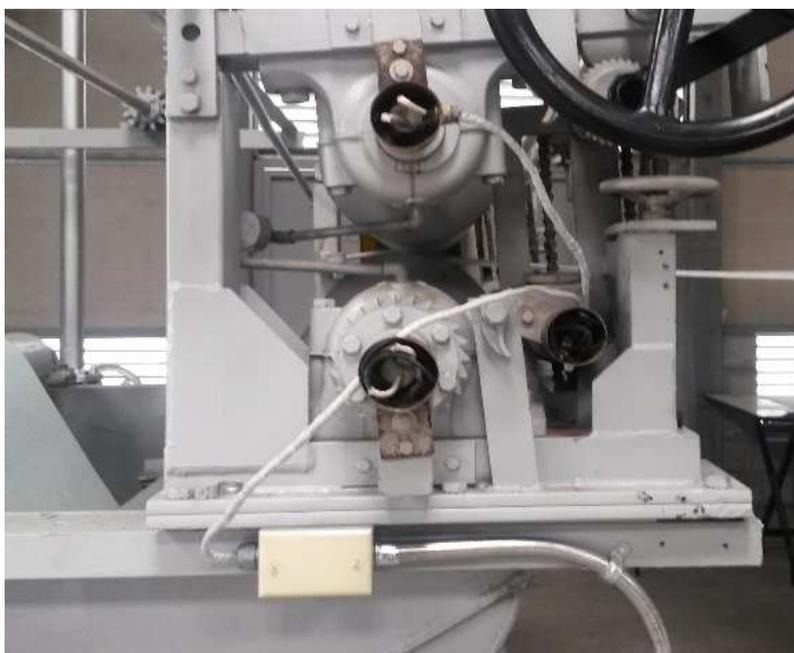
Figura 79 Instalación resistencias en molino
