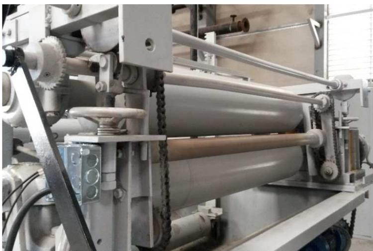
Figura 77 Molino laminador
