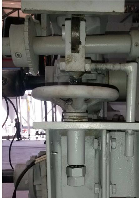
Figura 59 Tornillo de potencia impregnadora
