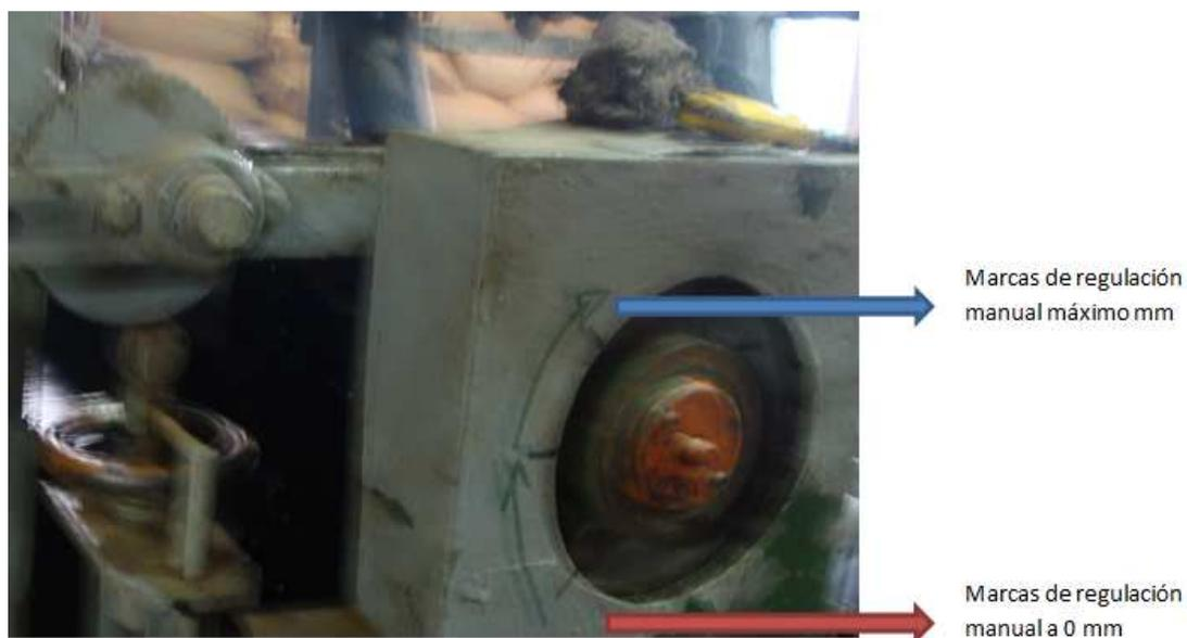
Figura 4 Regulación manual cilindros mínimo – máximo
