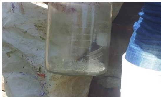
Figura 11. Recipiente de vidrio con bolitas de cristal para desfibrinar
