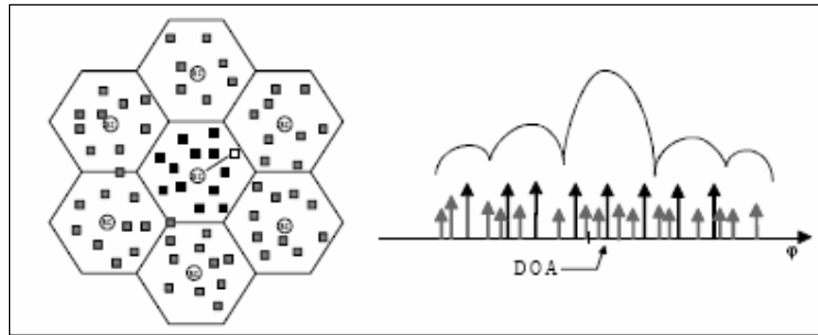
Figura 5.3. Patrón de radiación del sistema SDMA para sistemas CDMA. No existe “null steering”
