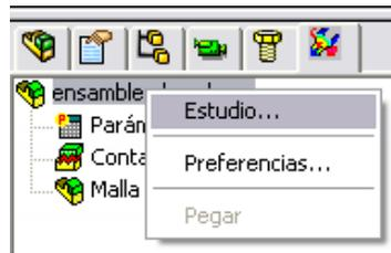
21. De un nombre al estudio, seleccione el tipo de análisis a realizar y el tipo de malla que se utilizará para el cálculo mediante elementos finitos.
