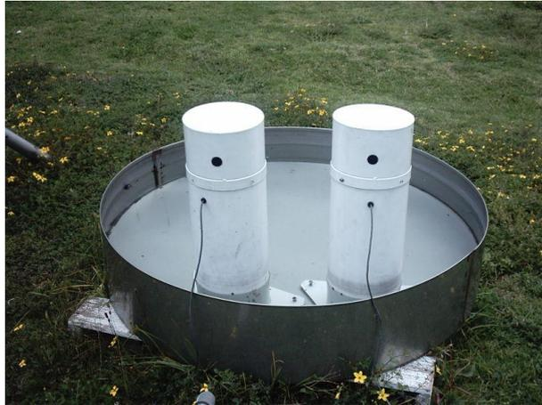
Figura 4.10 Tanque de evaporación – INAMHI
