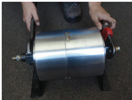
Figura 84. Ajuste de tuercas laterales
