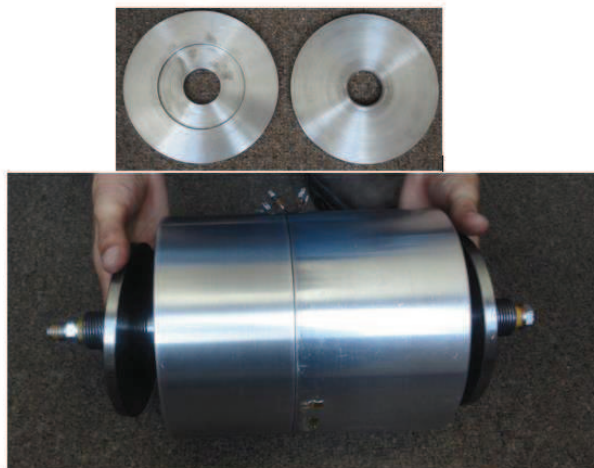
Figura 82. Colocación de diafragmas
