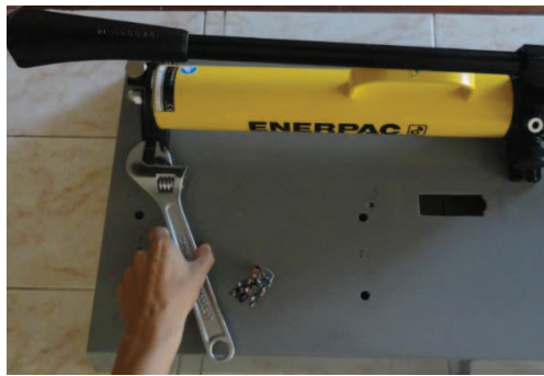
Figura 77. Anclaje de la bomba manual
