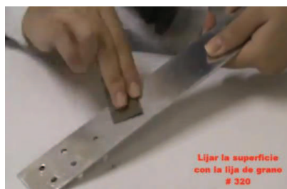
Figura 16. Lijado de la superficie
