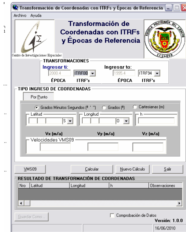
Figura. 4.2 Programa de Transformación de Coordenadas con ITRFs y Épocas de Referencia utilizando 7 parámetros.
