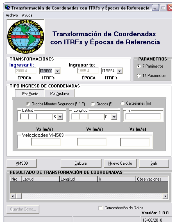
Figura. 4.3 Programa de Transformación de Coordenadas con ITRFs y Épocas de Referencia utilizando 7 y 14 parámetros.
