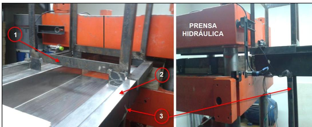
**Figura 5.15 Sistema de alimentación y Centrado**
