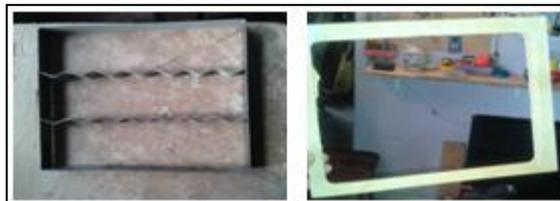
**Figura 3.2 Foto de la cuchilla rectangular para el proceso de troquelado y marco de madera troquelado**
