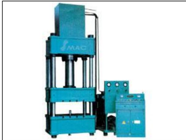
**Figura 2.1 Prensa hidráulica de simple acción**
