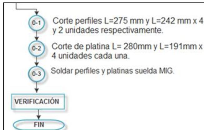
**Figura 5.3 Diagrama de flujo para la construcción de la estructura de apilación**
