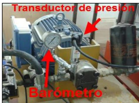
**Figura 5.18 Transductor de presión instalado**
