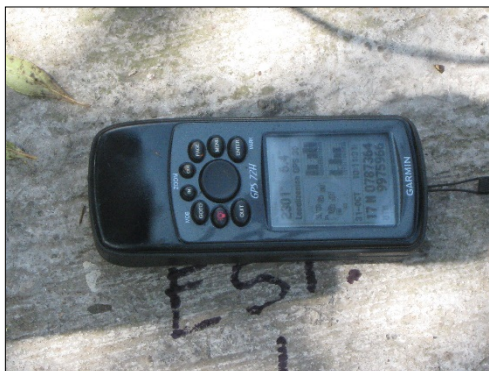
Figura 2: Instrumentación utilizada para el levantamiento topográfico (GPS)
