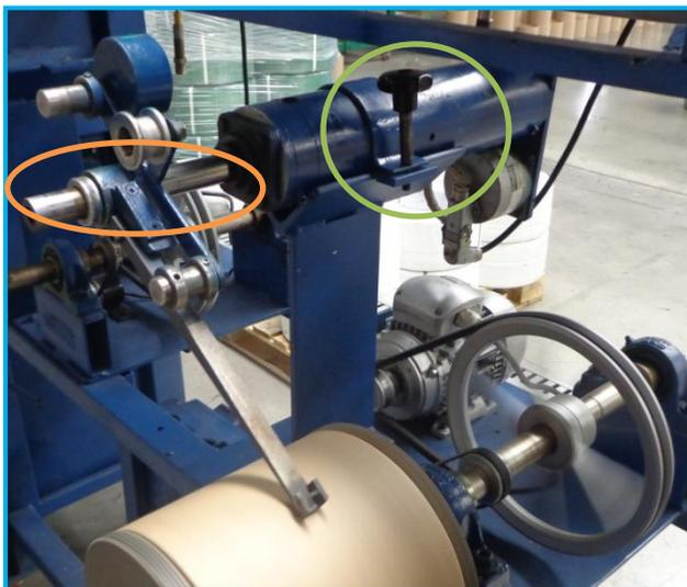
Figura 81.- Calibración de guía fleje
