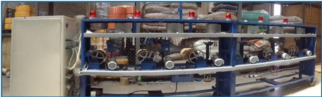
Figura 70. Canalización externa de actuadores y sensores
