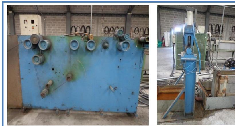
Figura 15. Sistema de Calibración y Tensión del Sistema de Extrusión Extruder #1
