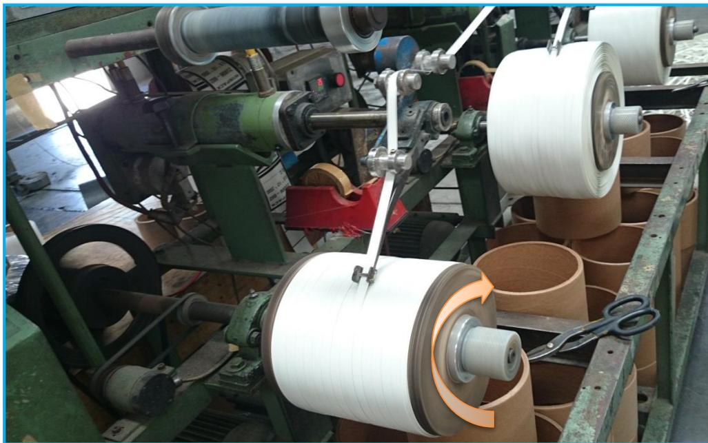
Figura 28. Rotación de eje a velocidad variable para enrollamiento de fleje tipo PP de 12 mm
