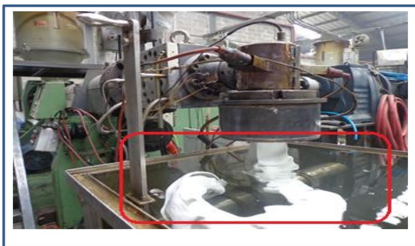
Figura 13. Expulsión de material Fundido por Boquilla
