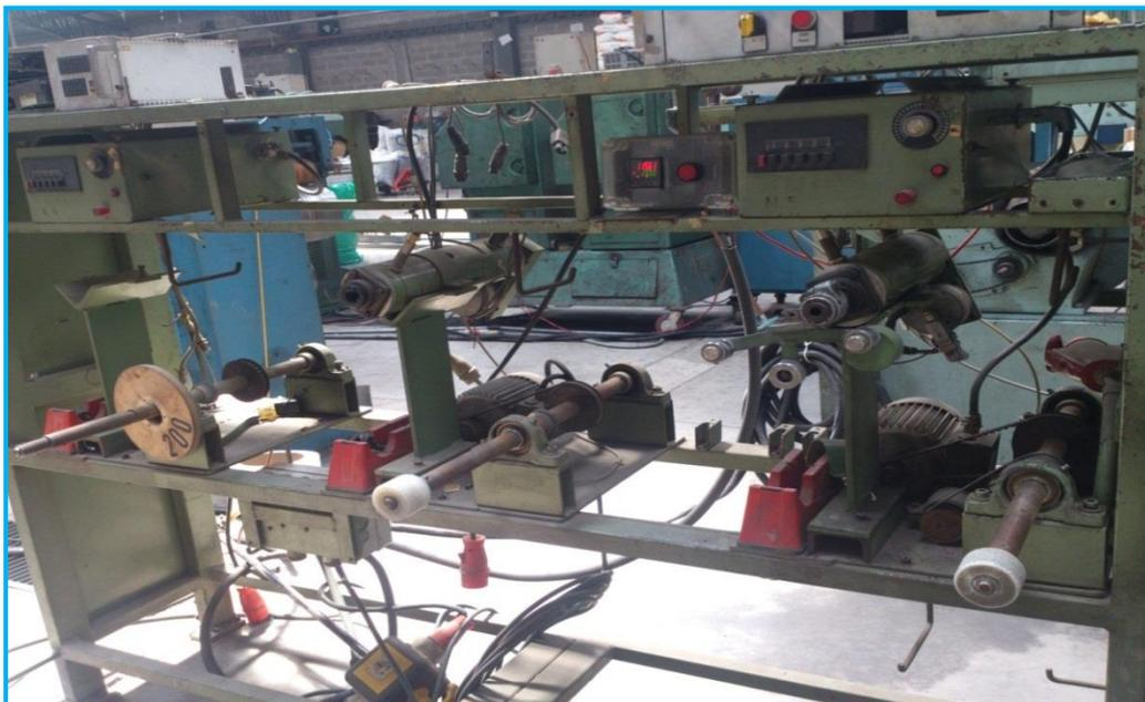
Figura 76. Sistema de bobinado de 3 partes antes de restauración
