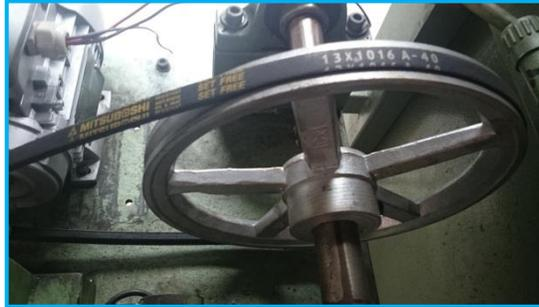
Figura 83. Alineación de polea del eje del carrete y motor trifásica
