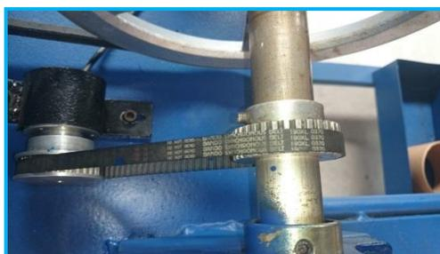
Figura 82. Alineación de encoder y eje de carrete
