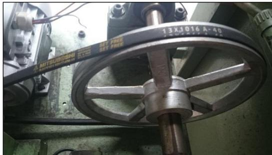
Figura 66. Transmisión mecánica motor de inducción eje de carrete
