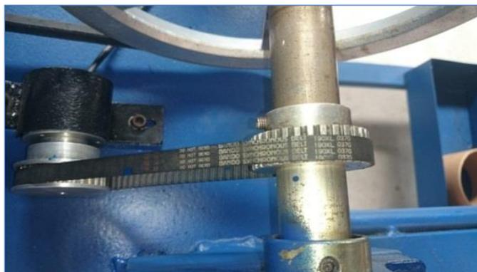
Figura 67. Transmisión mecánica entre encoder incremental y eje de carrete
