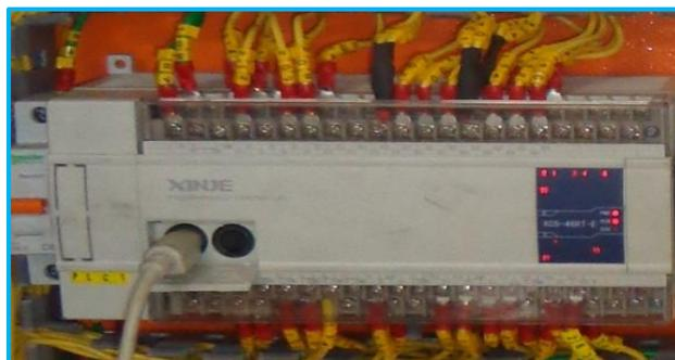
Figura 84.- Activación de entradas y salidas de PLC
