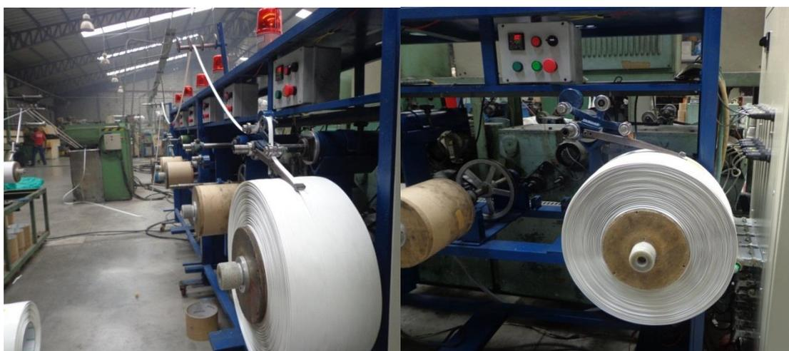
Figura 86. Bobinado de fleje de 12 mm en carrete de 180 mm
