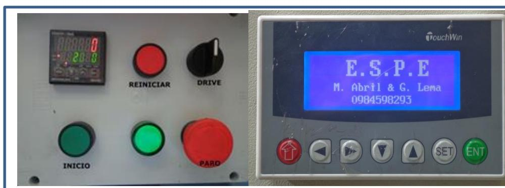
Figura 26. Señalización del Tablero de Control de la Bobinadora y Pantalla de Interfaz.
