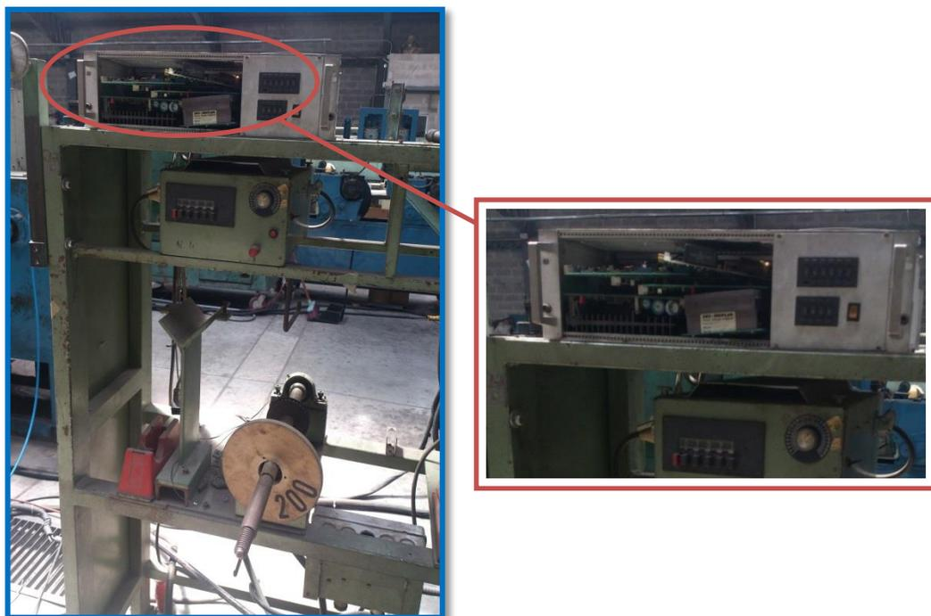
Figura 4. Sistema de Bobinado actualmente no operativo y tarjetas de control averiadas.
