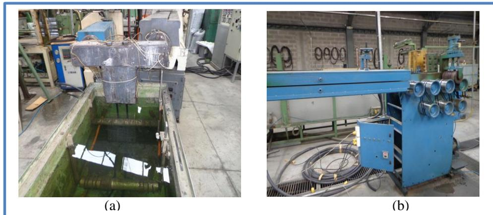
Figura 14. (a) Sistema de Enfriamiento y (b) Moldeado por Rodillos
