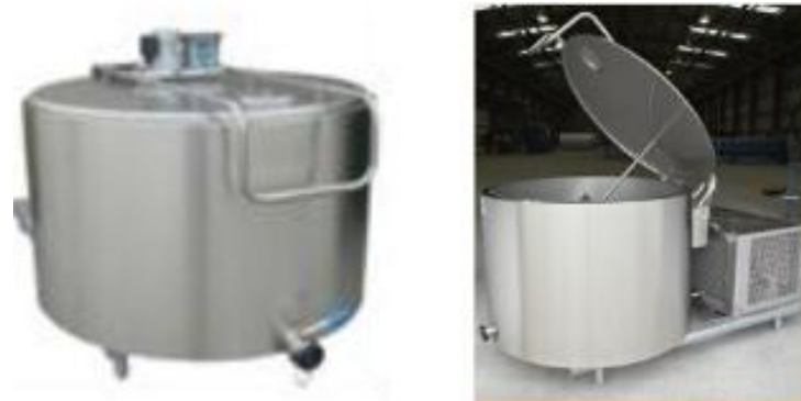
Figura 3.15. Tanque de Enfriamiento
