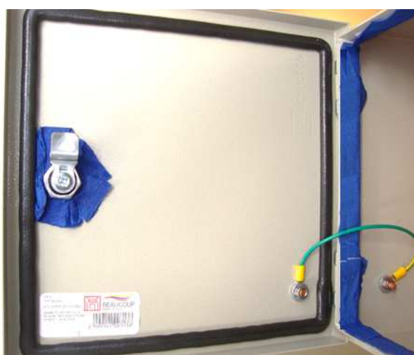
Figura 105 Inspección final puerta I-0311 - Prueba IPX1
