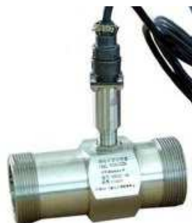
Figura 19 Transmisor de caudal
