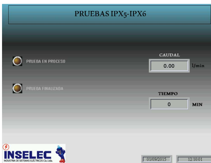
Figura 89 Pantalla prueba IPX5, IPX6
