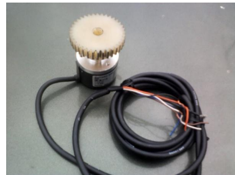
Figura 6: Encoder absoluto rotativo para censar ángulo del volante de la dirección
