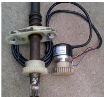
Figura 12: Colocación del sensor de ángulo
