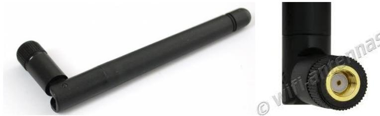
Figura 2. 7 Antena externa RPSMA
