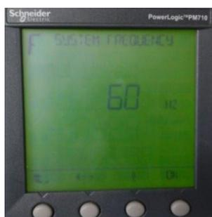
Figura 2. 20 Configuración de la frecuencia
