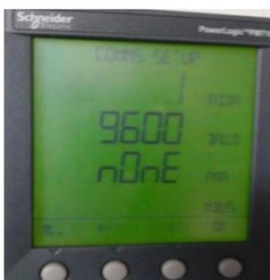
Figura 2. 23 Configuración de los parámetros de comunicación
