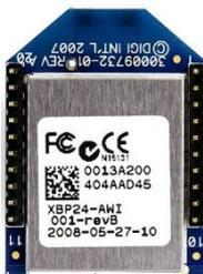
Figura 2. 32 Vista posterior de los módulos XBee empleados
