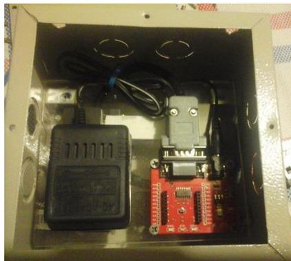
Figura 2. 14 Implementación del módulo XBee Explorer TX
