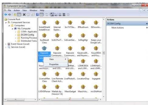
Figura 2. 68 Configuración seguridad DCOM para Kepware Server
