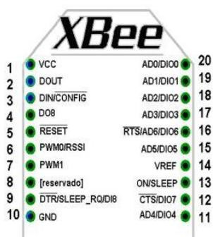
Figura 2. 6 Vista superior del módulo XBee
