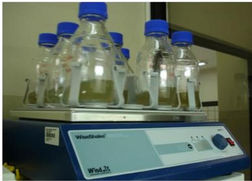
**Figura 3.7:** Agitación de los frascos Boeco de 500 mL conteniendo arsénico V y Cianobacterias en agua (Espíndola, 2008).
