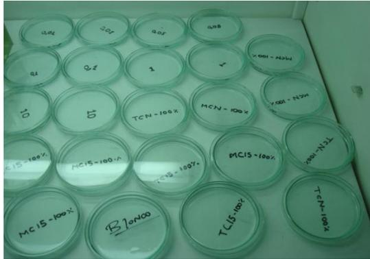
**Figura 3.24:** Ensayos de Toxicidad y sensibilidad realizados en cajas petri de 25mL con 10 *Daphnias* por cada caja
