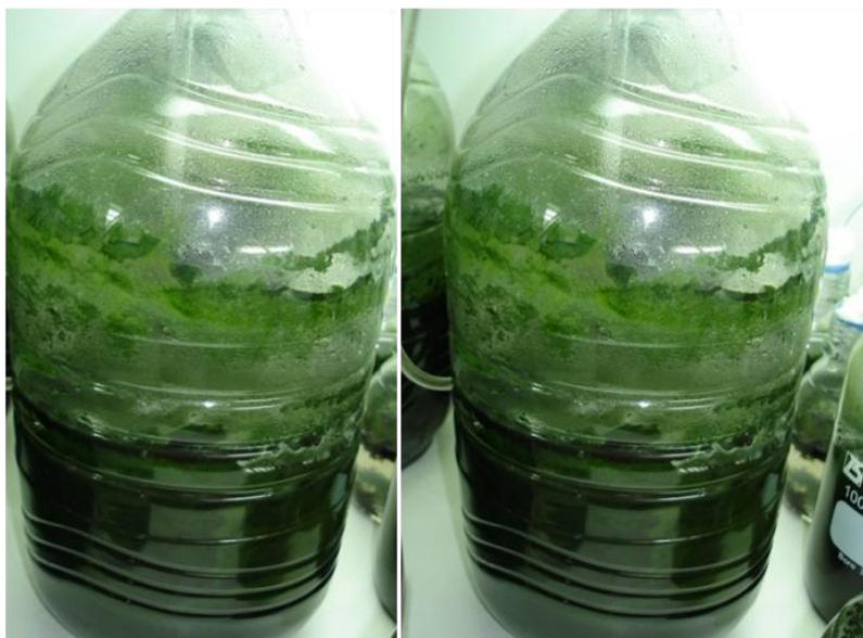
**Figura 3.2:** Reactores de 5 L donde se realizó la obtención masiva de biomasa cianobacteriana para los Ensayos con Arsénico (Espíndola, 2008).
