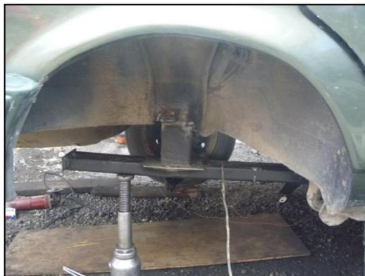
**Figura 4. 8:** Fijación de la estructura del semi-chasis posterior a la carrocería
