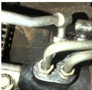
**Figura 4. 22:** Conducto alta presión del cilindro
