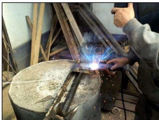
**Figura 4. 3:** Construcción de larguero del semi-chasis posterior.
