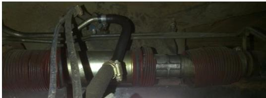
**Figura 4. 20:** Mecanismo de asistencia hidráulica para la dirección posterior adaptado en el semi-chasis posterior.
