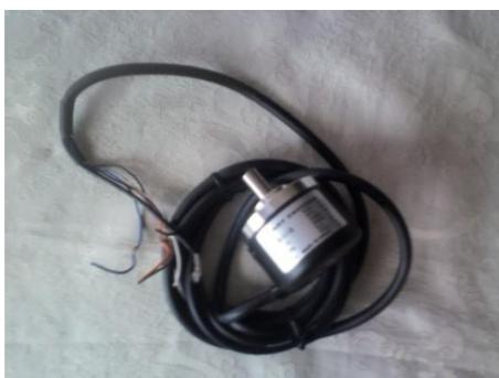
**Figura 2. 40:** Encoder absoluto rotativo con interface
