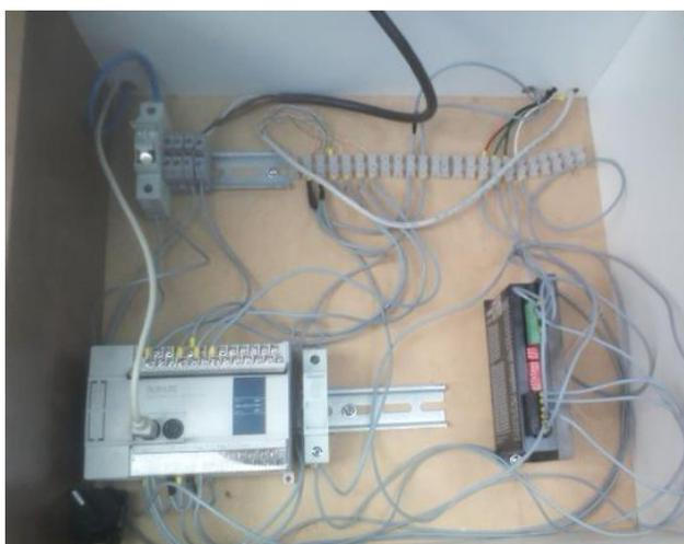
**Figura 4. 31:** Instalación de elementos electrónicos del sistema de control electrónico de asistencia a la dirección posterior.
