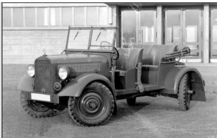
**Figura 2. 21:** MERCEDES BENZ 170 VL. El primer vehículo con las cuatro ruedas directrices.
