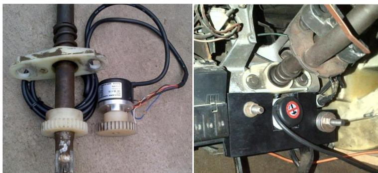
**Figura 4. 28:** Implementación del sensor de ángulo de giro del volante de la dirección
