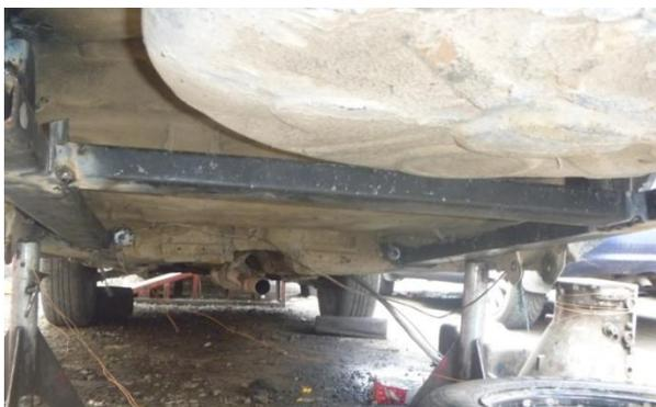
**Figura 4. 7:** Semi-chasis posterior implementado en el vehículo.
