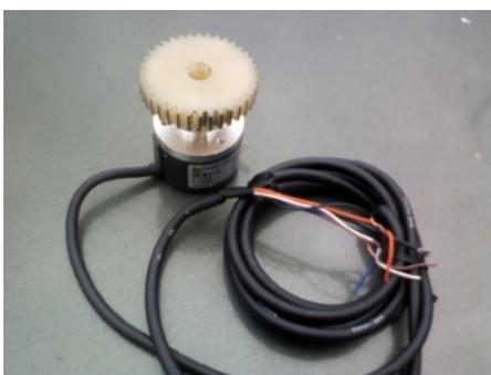
**Figura 3. 36:** Encoder rotativo para sensar ángulo del volante de la dirección
