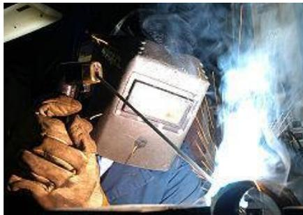
**Figura 2. 51:** Soldadura por arco eléctrico.
