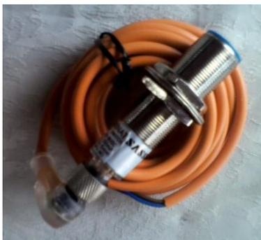
Figura 7: Sensor magnético para velocidad del vehículo.
