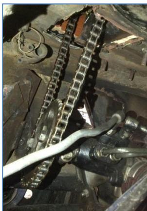
**Figura 4. 27:** Implementación del sistema de transmisión de par a la dirección posterior.
