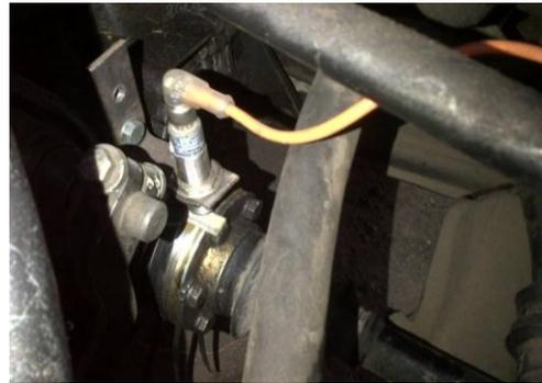
Figura 13: Ubicación del sensor de giro.
