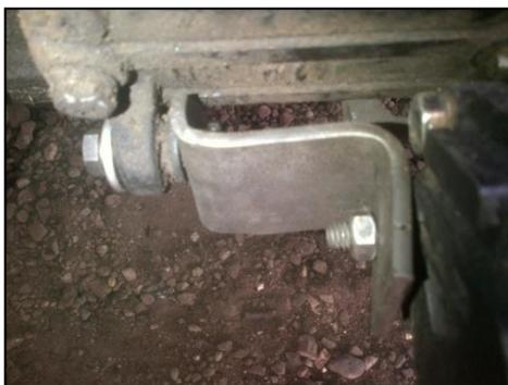
**Figura 4. 12:** Sujetador de la bomba para la dirección posterior
