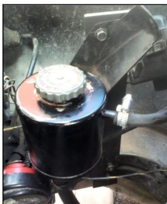
**Figura 4. 16:** Deposito Hidráulico.
