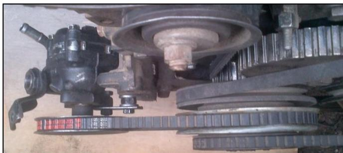
**Figura 4. 15:** Banda en V instalada.
