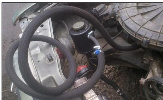
**Figura 4. 19:** Manguera de retorno acoplada
