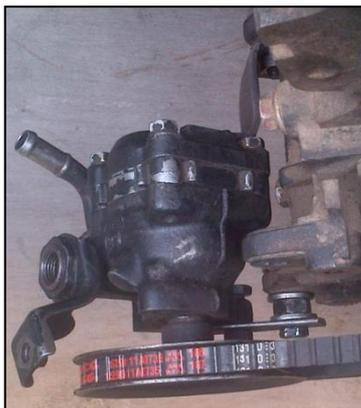
**Figura 4. 13:** Bomba para la dirección posterior instalada.
