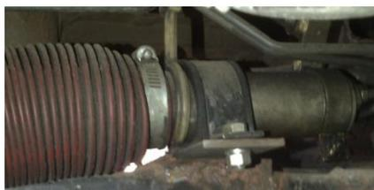
**Figura 4. 21:** Bases de acoplamiento del cilindro de dirección posterior.
