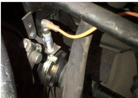
**Figura 4. 29:** Ubicación del sensor de velocidad del vehículo prototipo.
