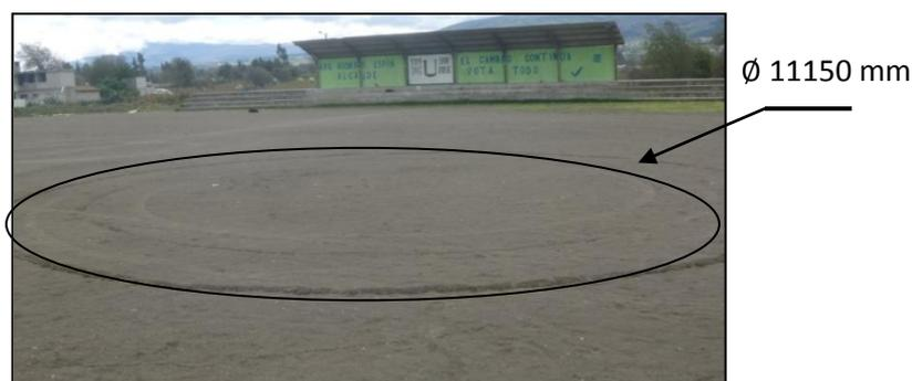
**Figura 5. 7:** Esquema del diámetro de giro del vehículo.
