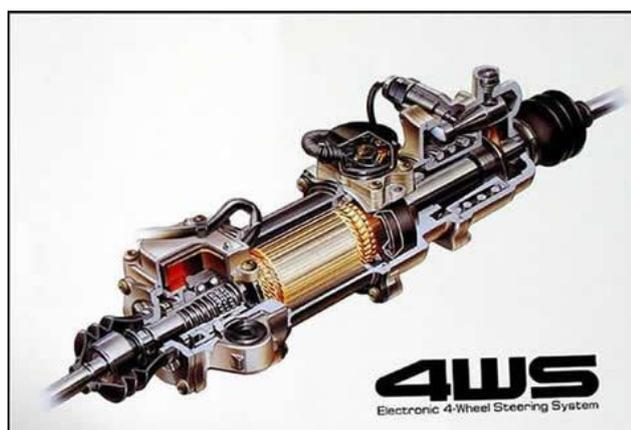
**Figura 2. 27:** Actuador de la dirección posterior.
