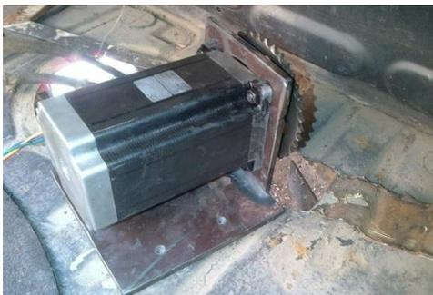
**Figura 4. 25:** Acoplamiento del actuador a la carrocería
