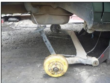
**Figura 4. 1:** Eje posterior desmontado
