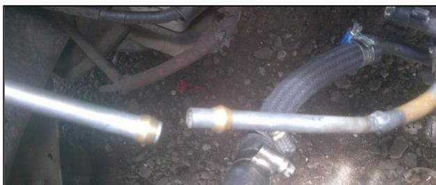
**Figura 4. 18:** Unión de la cañería de presión
