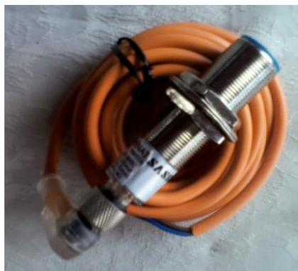
**Figura 3. 37:** Sensor magnético para velocidad del vehículo.
