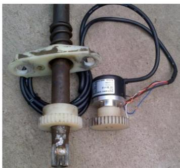
Figura 12: Colocación del sensor de ángulo
