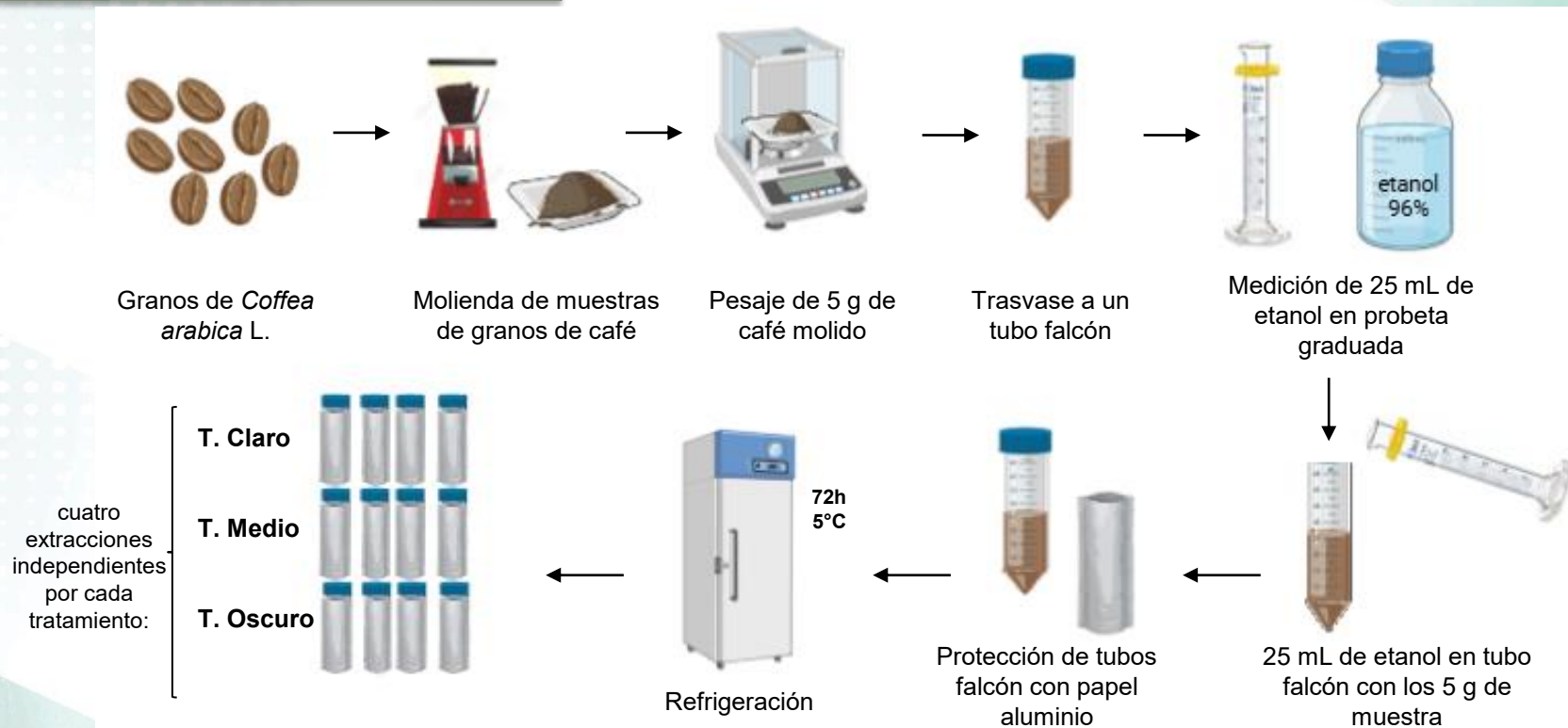
Figura 21. Extracción de principios activos de granos de Coffea arabica L.; realizado por Cachumba, I. en Biorender, 2026
