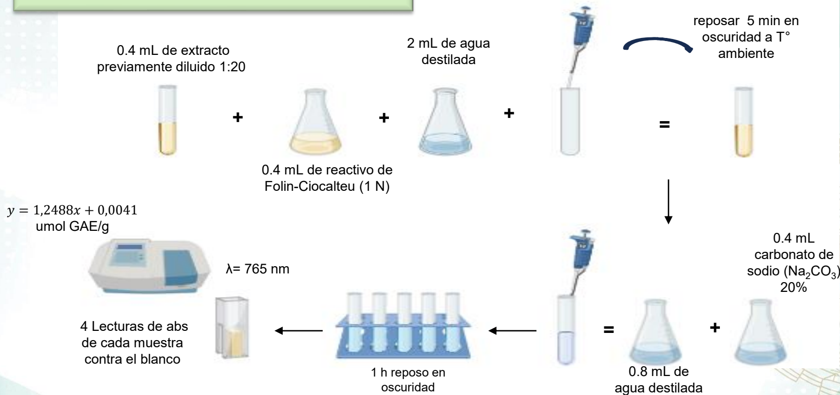
Figura 24. Ensayo con Folin Ciocalteu; realizado por Cachumba, I. en Biorender, 2026
