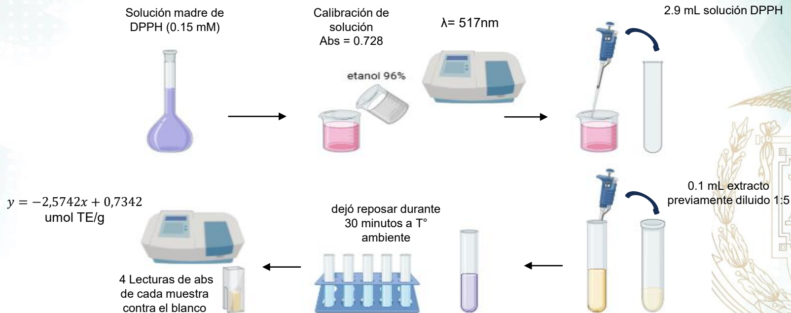
Figura 22. Ensayo DPPH; realizado por Cachumba, I. en Biorender, 2026
