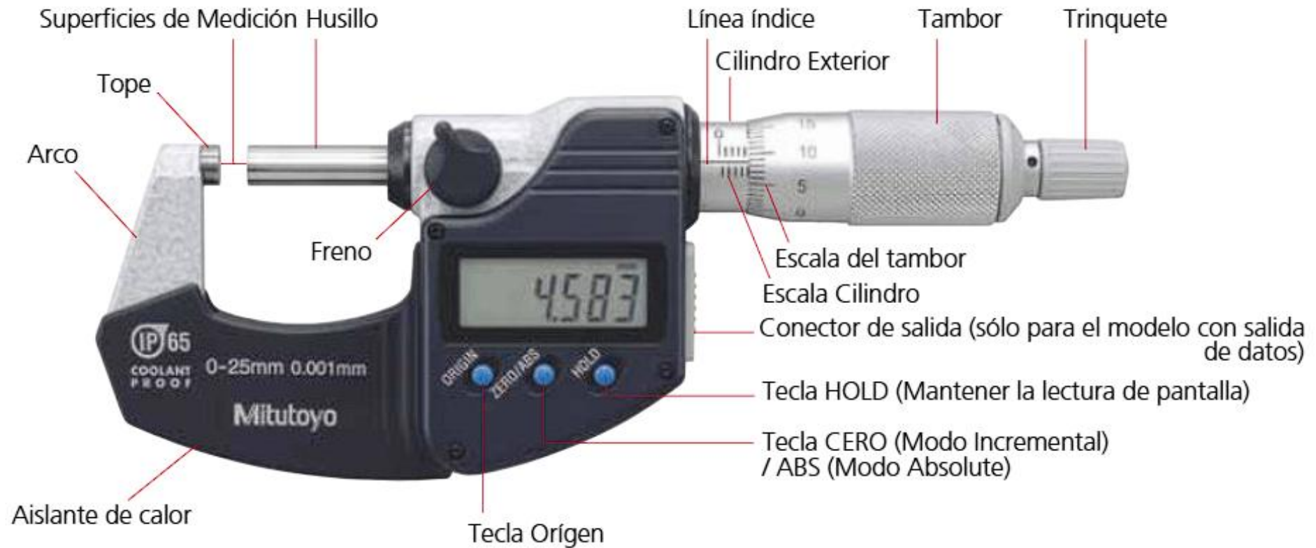
Figura 1. Partes de un micrómetro digital
