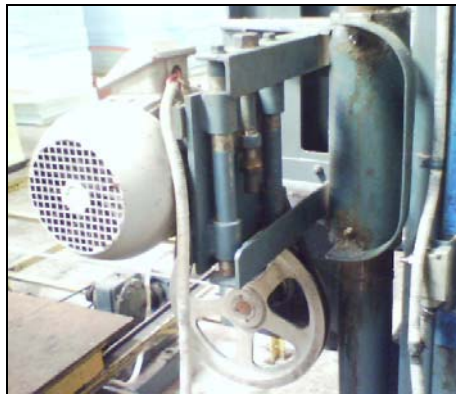
Figura. 1.3. Motor para girar la cuchilla acoplado con una banda al primer eje
