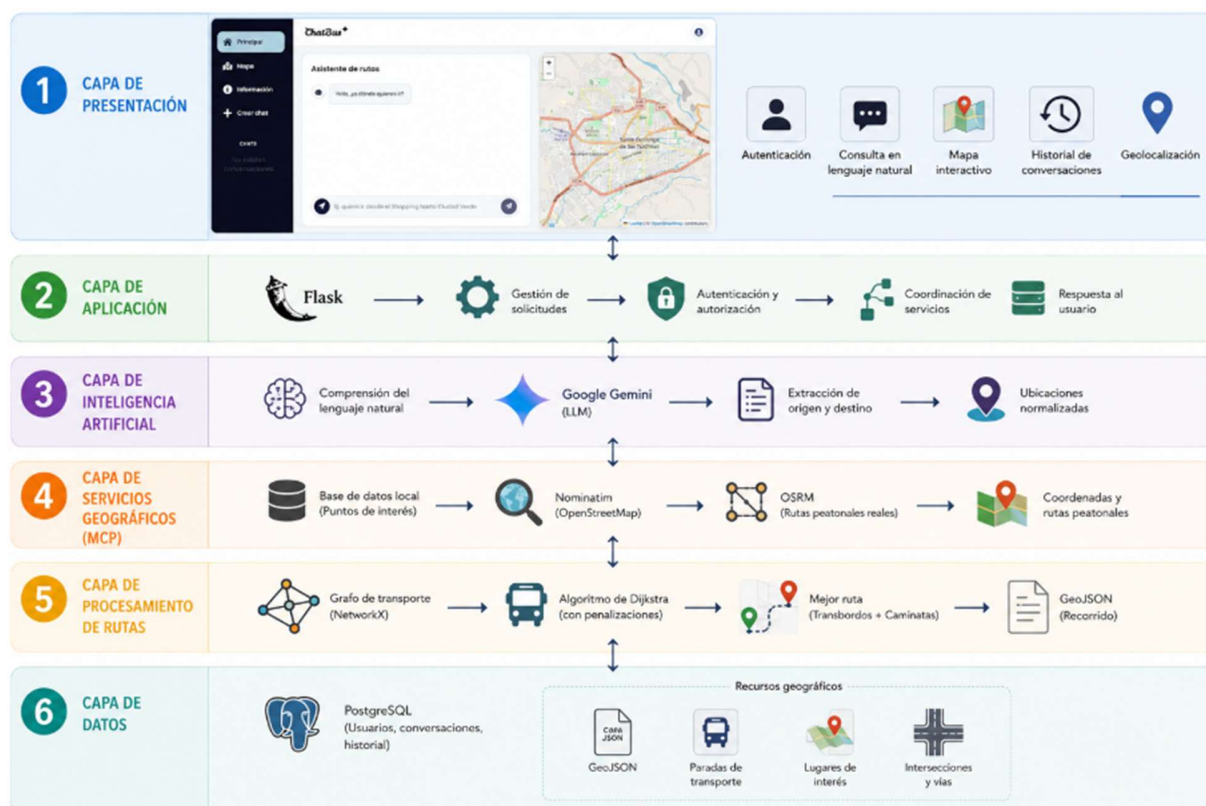
Figura 1 Arquitectura general de la plataforma conversacional
