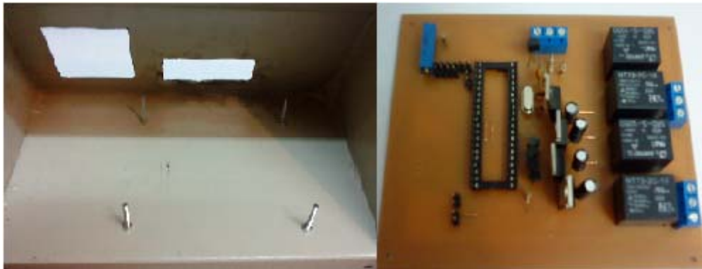
Figura 3.27. Interior del tablero de control y tarjeta principal a colocarse
