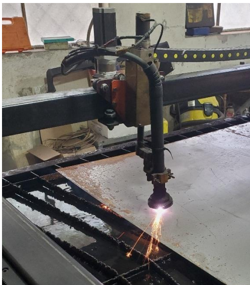
Figura 17. Corte plasma CNC de las piezas del separador ciclónico
