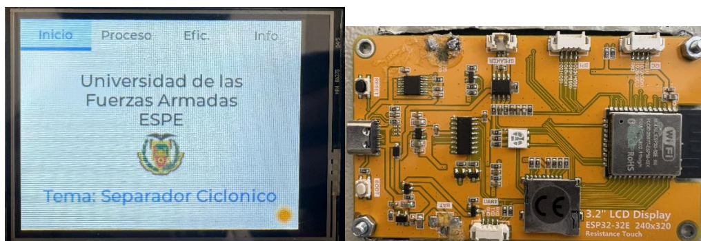
Figura 26. Módulo de pantalla HMI basado en ESP32-32E para la visualización de datos
