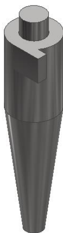
Figura 4. Modelo tridimensional del separador ciclónico desarrollado en Autodesk Inventor
